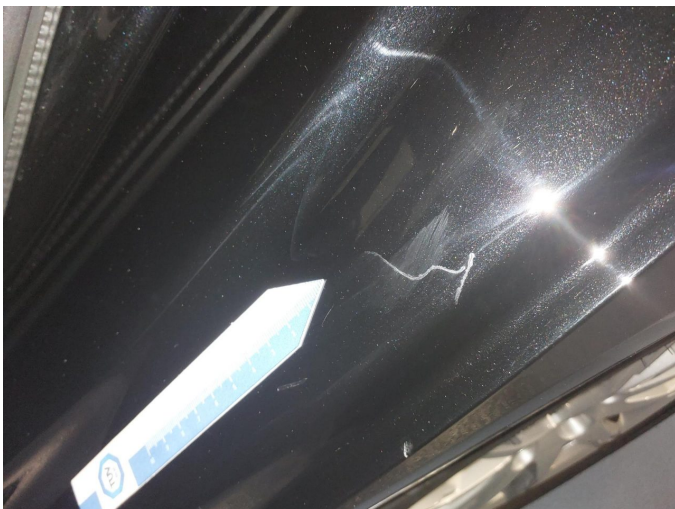
Gebrauchsspur 4: Seitenwand links: Einstieg - Kratzer - auslegen / polieren
