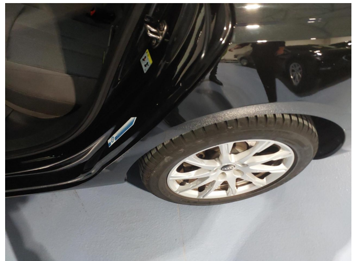
Gebrauchsspur 4: Seitenwand links: Einstieg - Kratzer - auslegen / polieren
