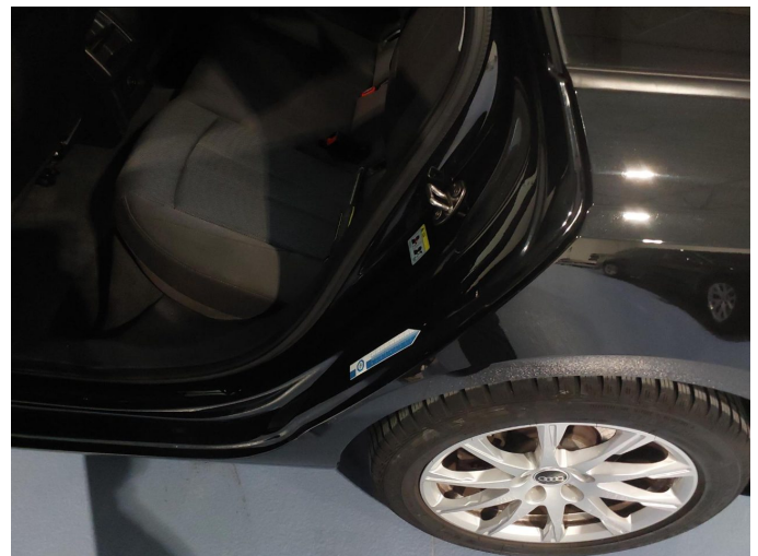
Gebrauchsspur 1: Seitenwand links: Einstieg - Delle(n) - kein Abzug
