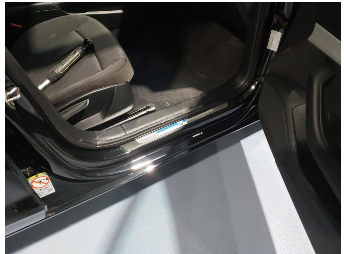
Gebrauchsspur 3: Schweller rechts: Einstieg - Delle(n) - kein Abzug
