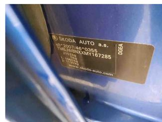
Fahrzeug - Typenschild/Fahrgestellnummer
