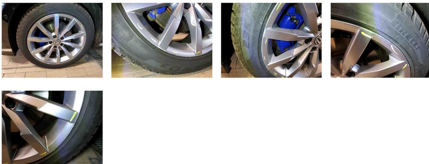
8 - Reifen hinten rechts - Riss - Ersetzen
