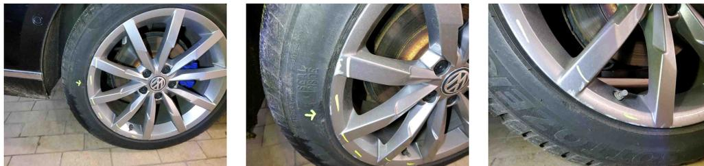
7 - Alufelge vorne links - Kratzer - Instandsetzen + lackieren
