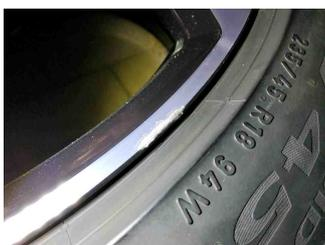
5 - Alufelge vorne rechts - Kratzer - Instandsetzen + lackieren
