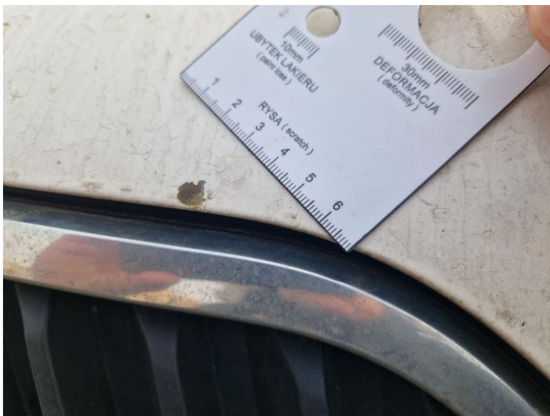
Fot. 37 Pokrywa komory silnika - Rysa/odprysk 1
