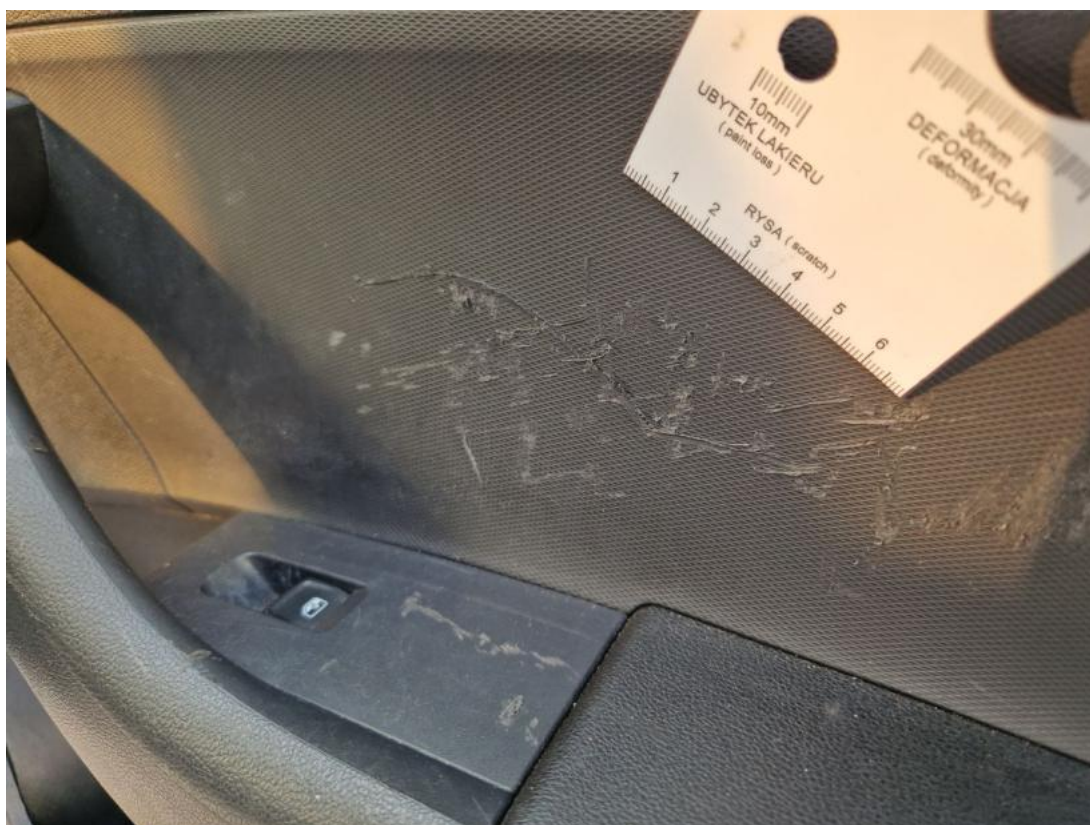
Fot. 77 Tapicerka drzwi tylnych P - Rysa/odprysk 1
