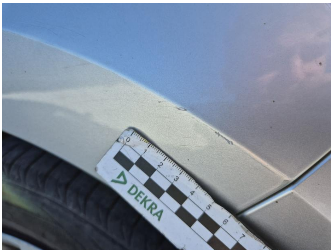
Fot. 36 Błotnik przedni P - Rysa/odprysk 1
