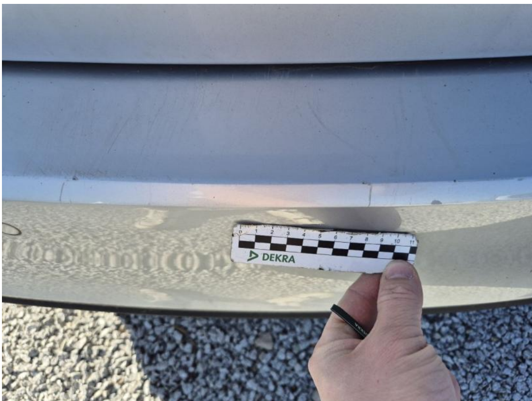
Fot. 46 Zderzak tylny - Rysa/odprysk 2
