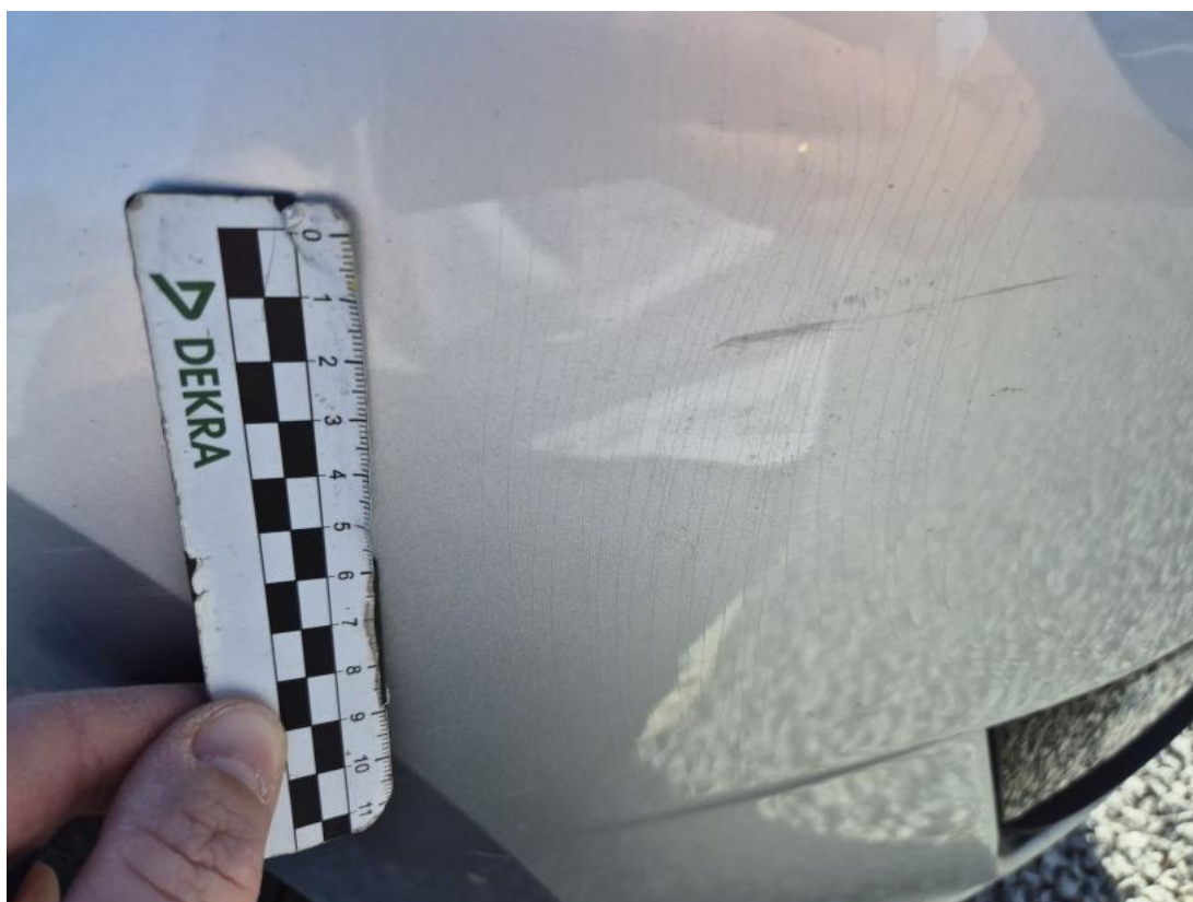
Fot. 35 Zderzak - Wgniecenie/odkształcenie 1
