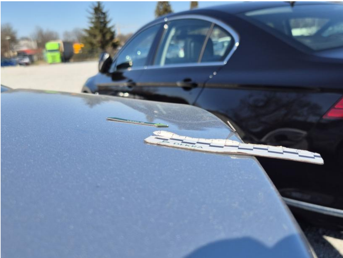
Fot. 43 Pokrywy bagażnika - Wgniecenie/odkształcenie 1
