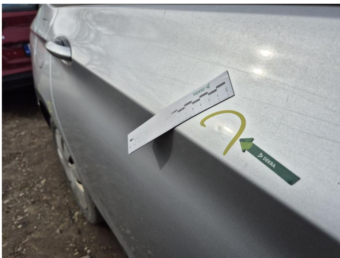
Fot. 38 Drzwi tylne P - Wgniecenie/odkształcenie 1
