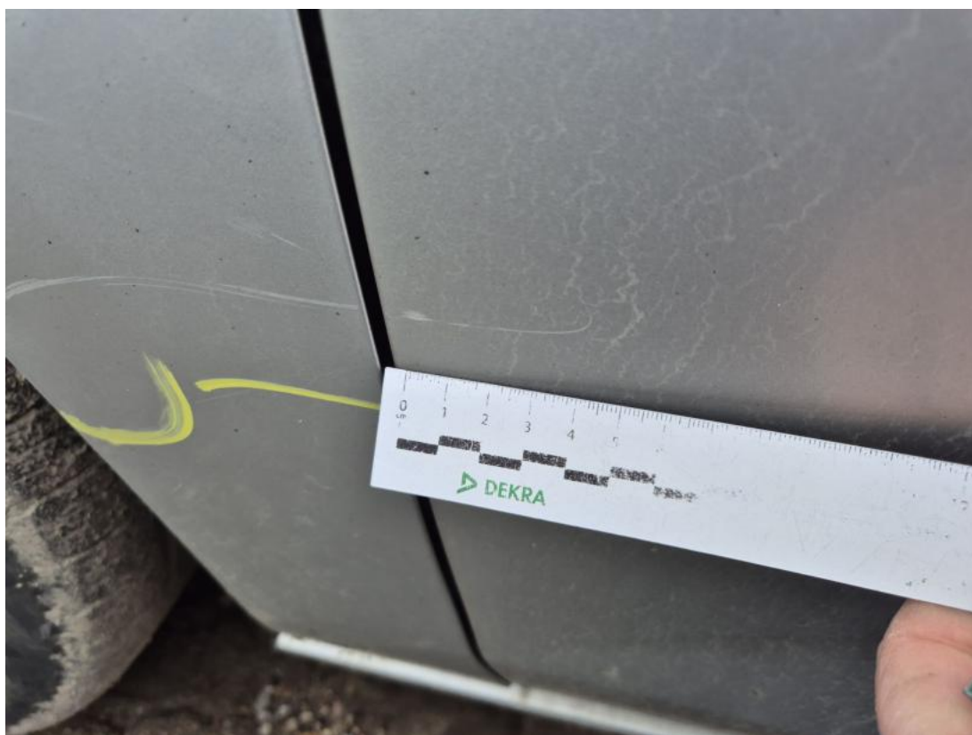
Fot. 45 Drzwi przed L() - Rysa/odprysk 3
