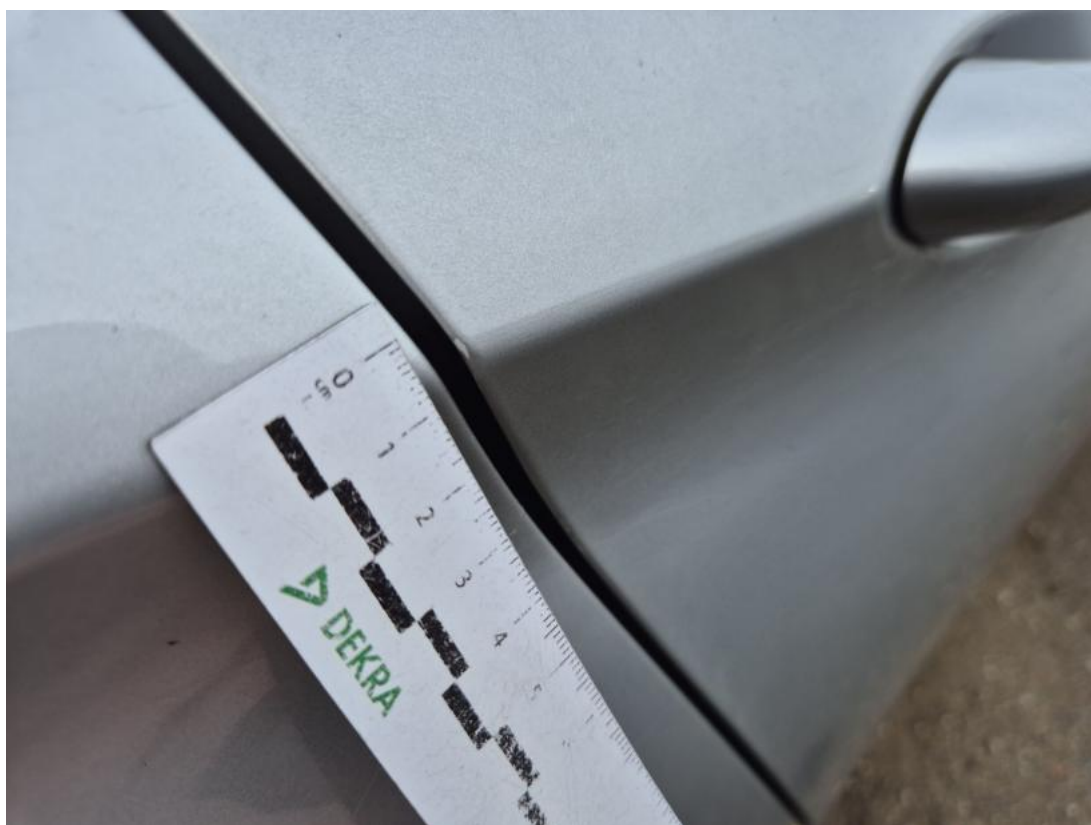
Fot. 37 Drzwi tylne P - Rysa/odprysk 1
