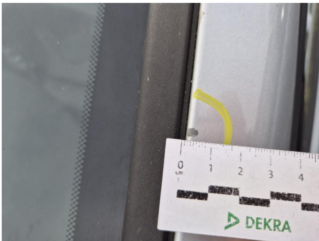
Fot. 48 Słupek przedni L - Rysa/odprysk 1
