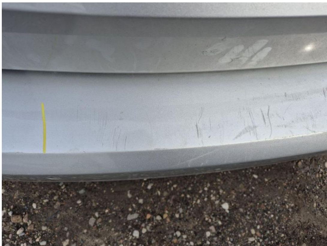
Fot. 41 Zderzak tylny - Rysa/odprysk 2
