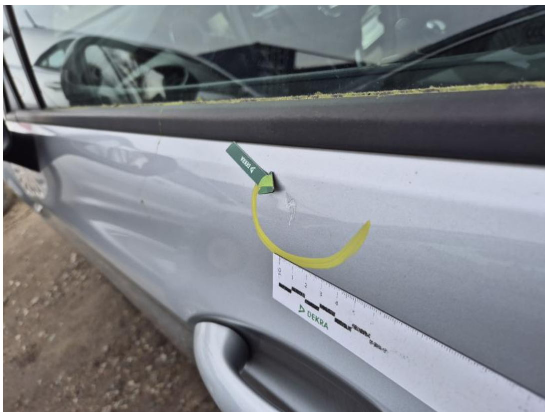
Fot. 46 Drzwi przed L - Wgniecenie/odkształcenie 1
