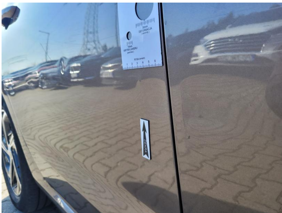
Fot. 48 Drzwi tylne P - Wgniecenie/odkształcenie 1
