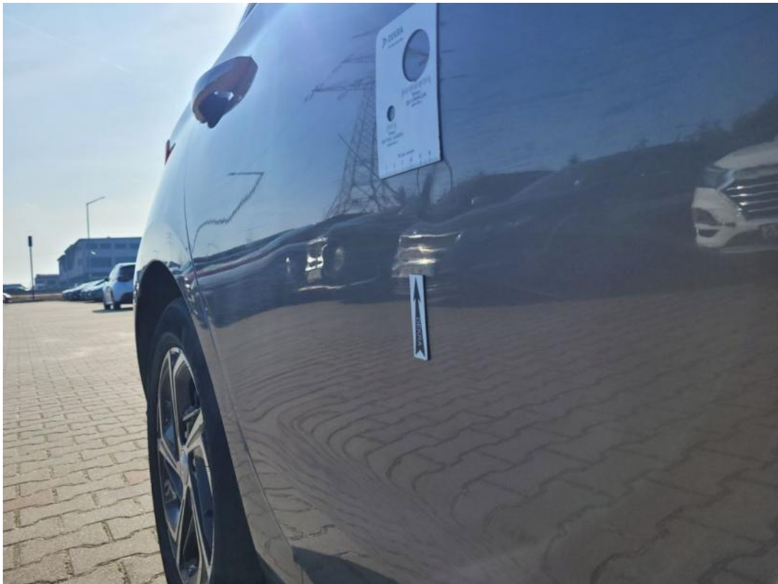
Fot. 49 Drzwi tylne P - Wgniecenie/odkształcenie 2
