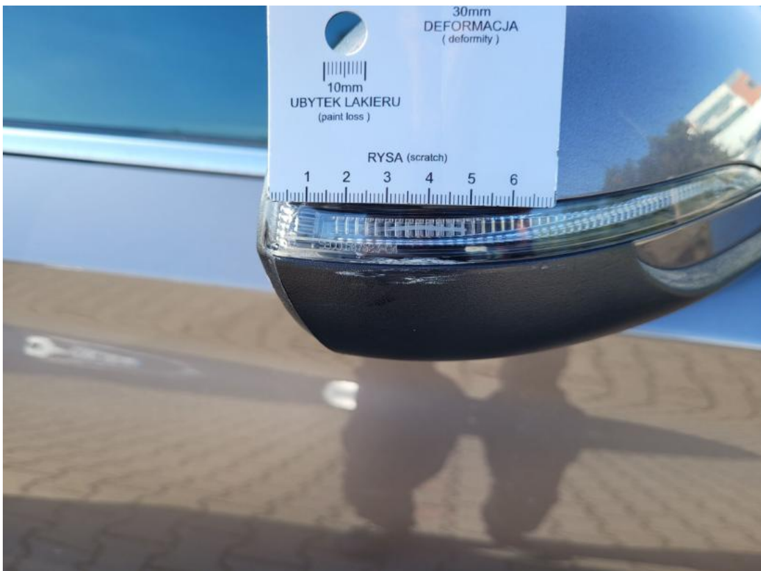
Fot. 50 Obudowa lusterka zew P - Rysa/odprysk 1
