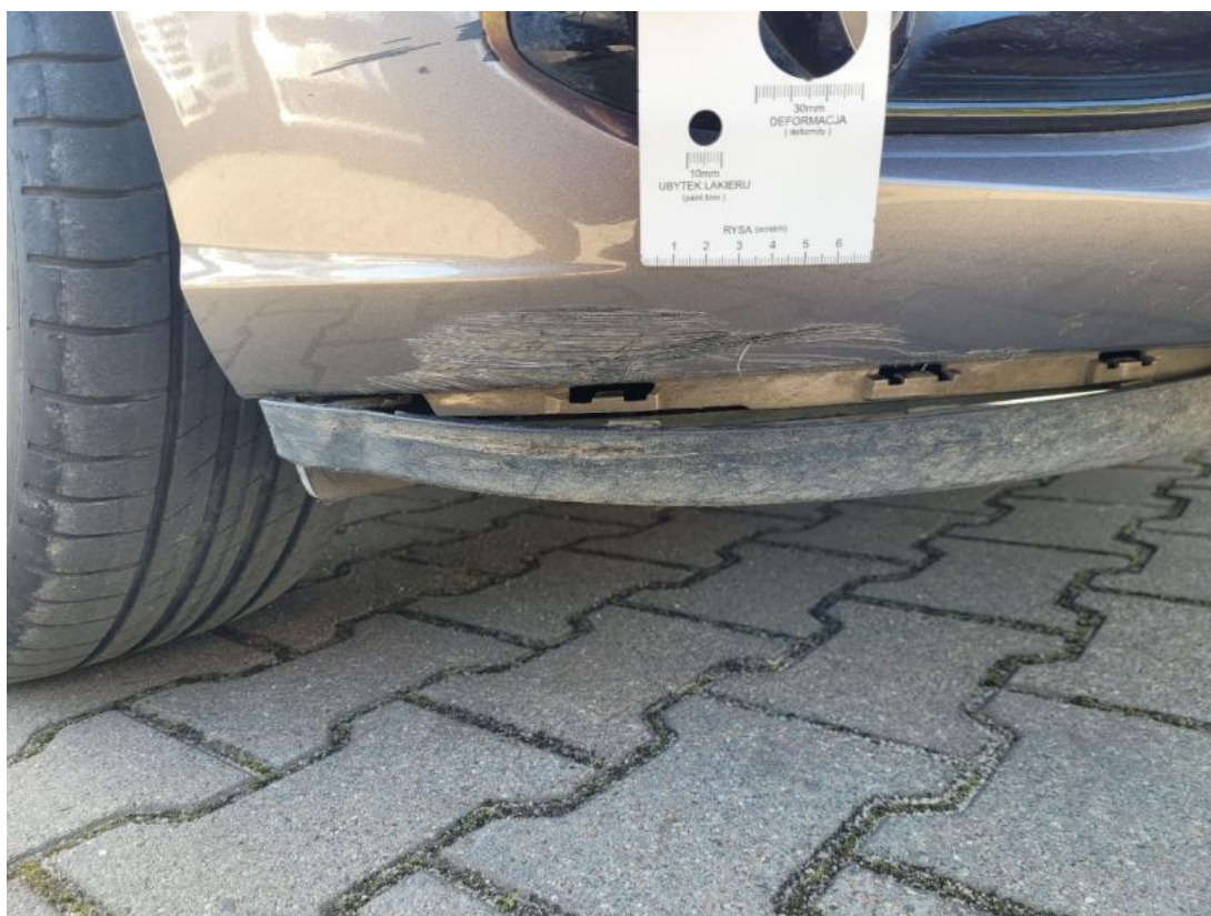
Fot. 35 Zderzak - Rysa/odprysk 2
