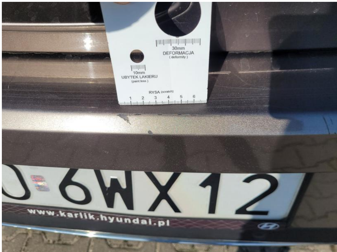
Fot. 57 Zderzak tylny - Rysa/odprysk 1
