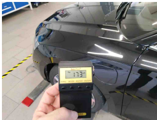
Lackstärke Kotflügel vorne links
