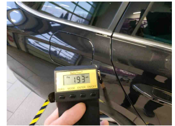
Lackstärke Seitenwand hinten rechts
