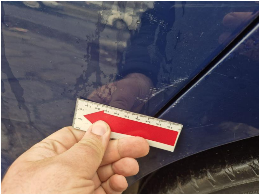
Fot. 55 Drzwi tylne L - Rysa/odprysk 1
