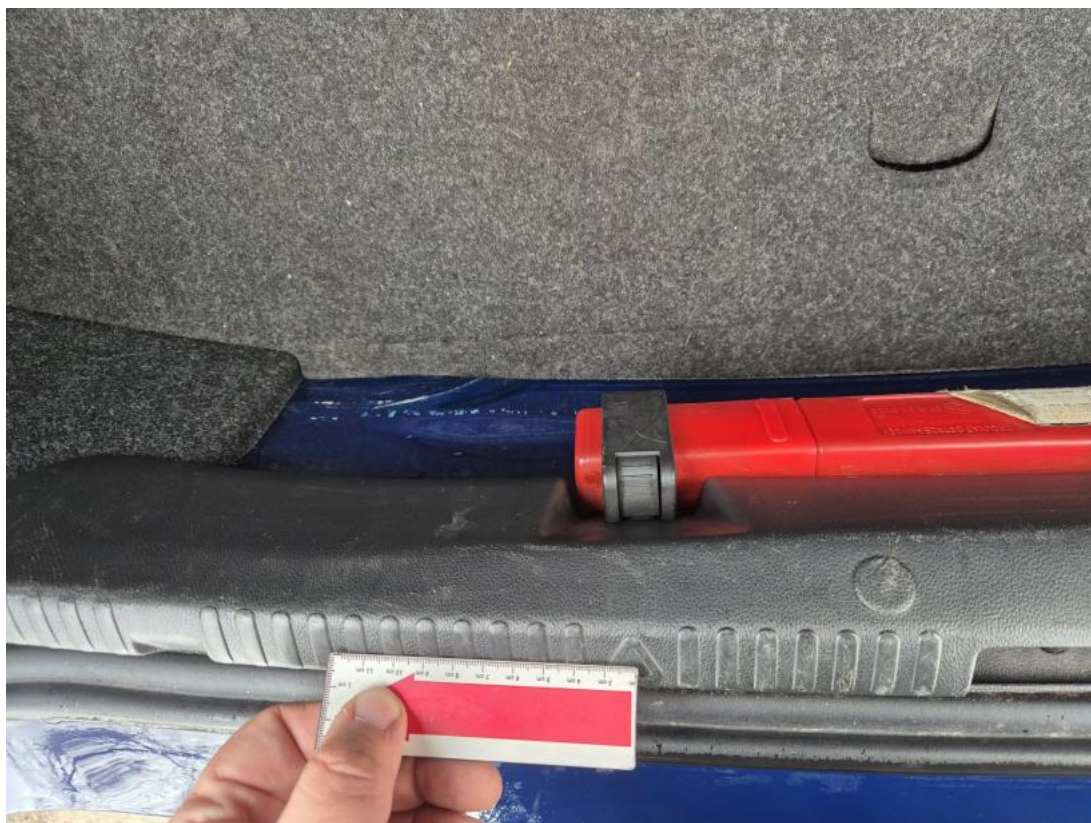
Fot. 59 Wykładzina przestrzeni bagażowej - Rysa/odprysk 1
