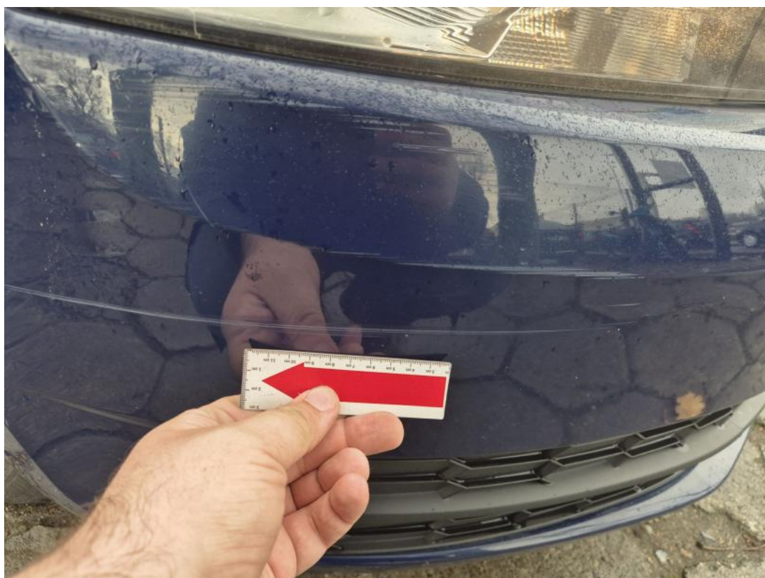
Fot. 36 Zderzak - Rysa/odprysk 2
