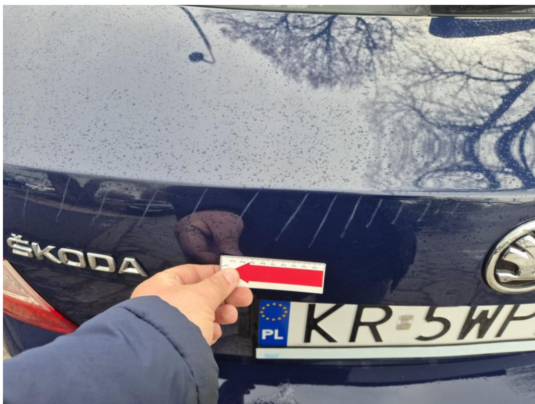
Fot. 47 Pokrywy bagażnika - Rysa/odprysk 1
