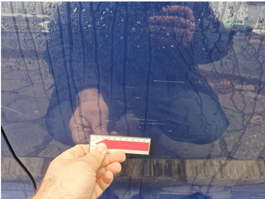
Fot. 56 Drzwi tylne L - Rysa/odprysk 2
