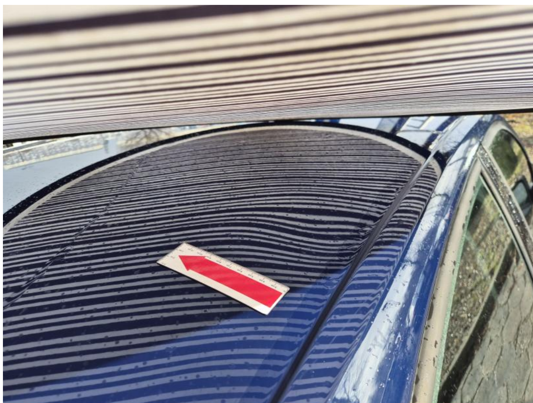
Fot. 48 Dach - Wgniecenie/odkształcenie 1
