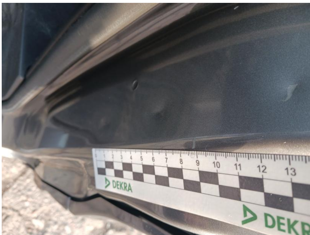
Fot. 68 Słupek środkowy L - Wgniecenie/odkształcenie 1
