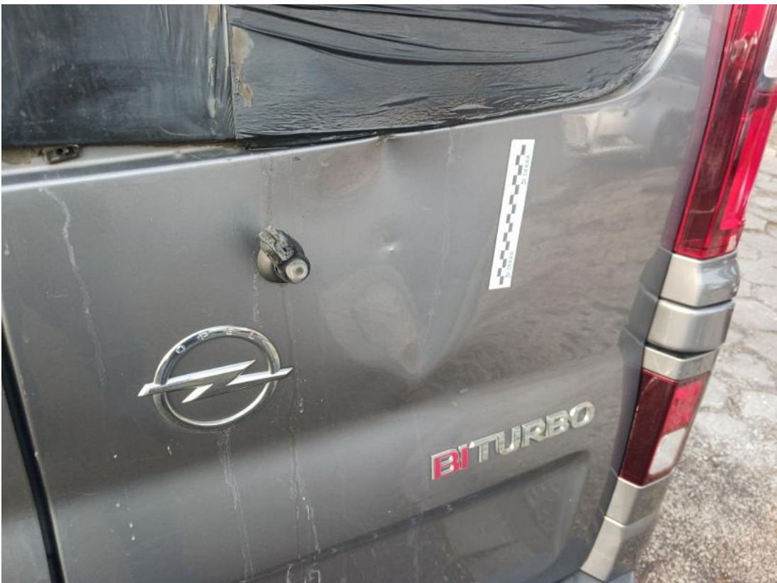
Fot. 48 Pokrywy bagażnika - Wgniecenie/odkształcenie 1
