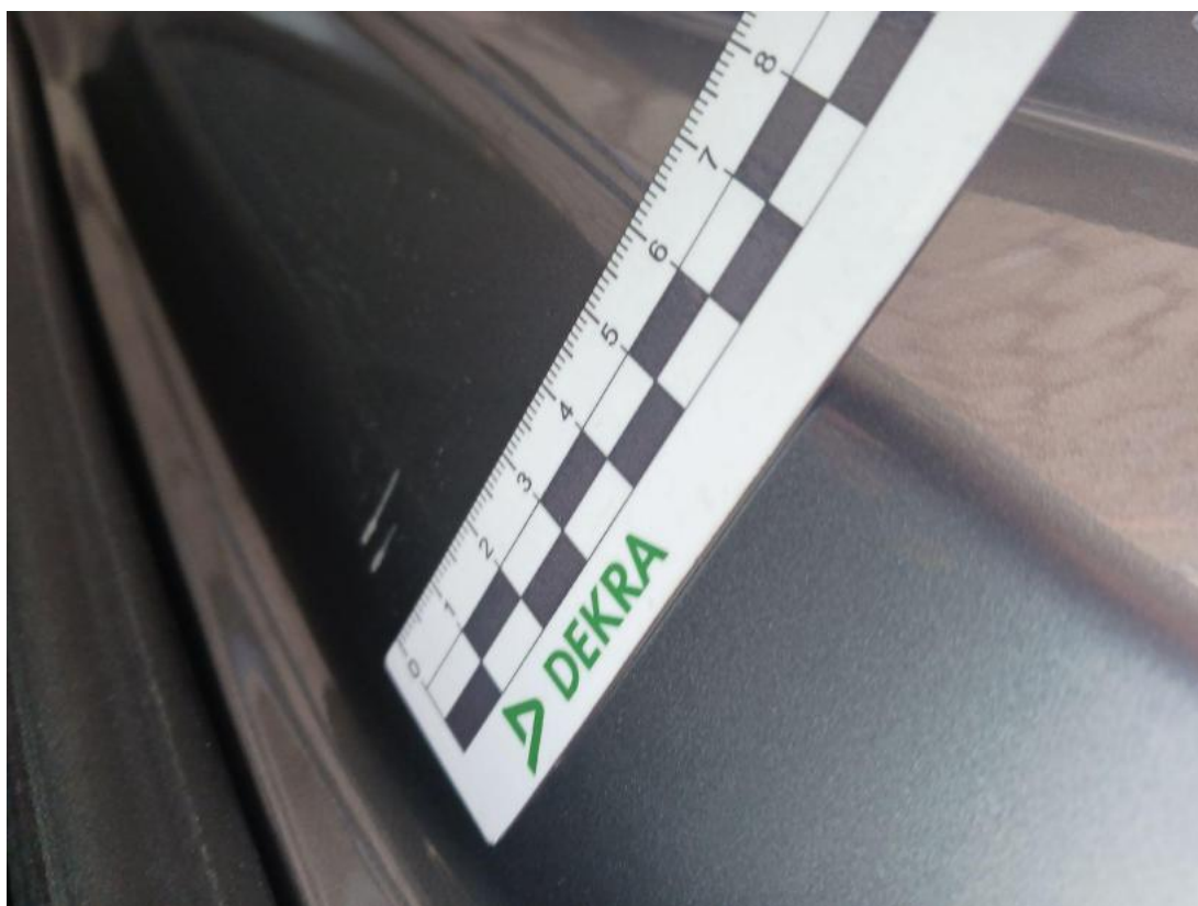
Fot. 46 Słupek środkowy P - Rysa/odprysk 1
