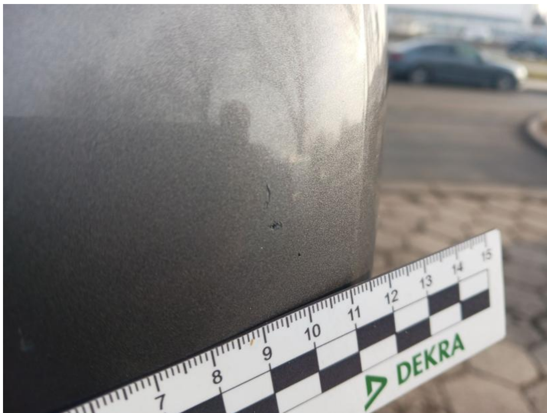
Fot. 63 Obudowa lusterka zew L - Rysa/odprysk 2
