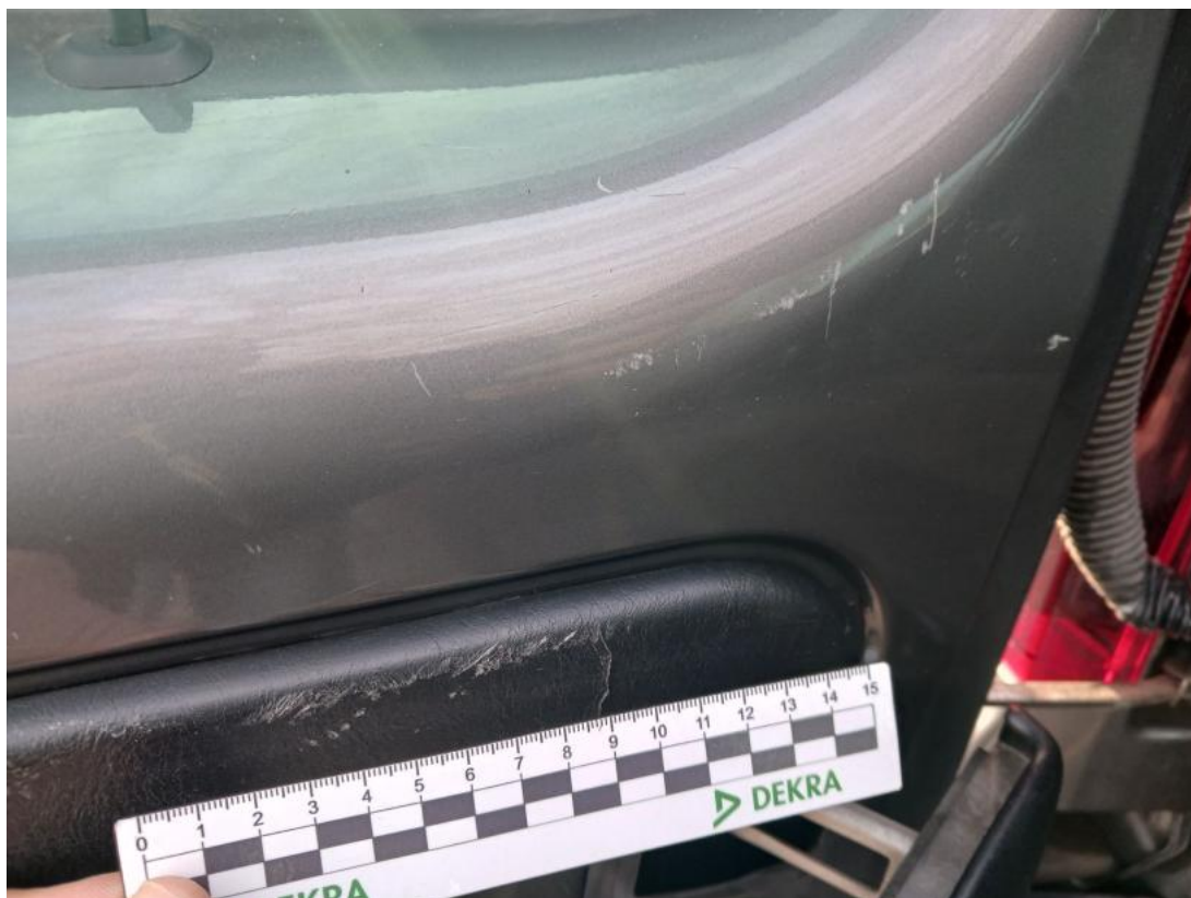
Fot. 75 Drzwi - Rysa/odprysk 1
