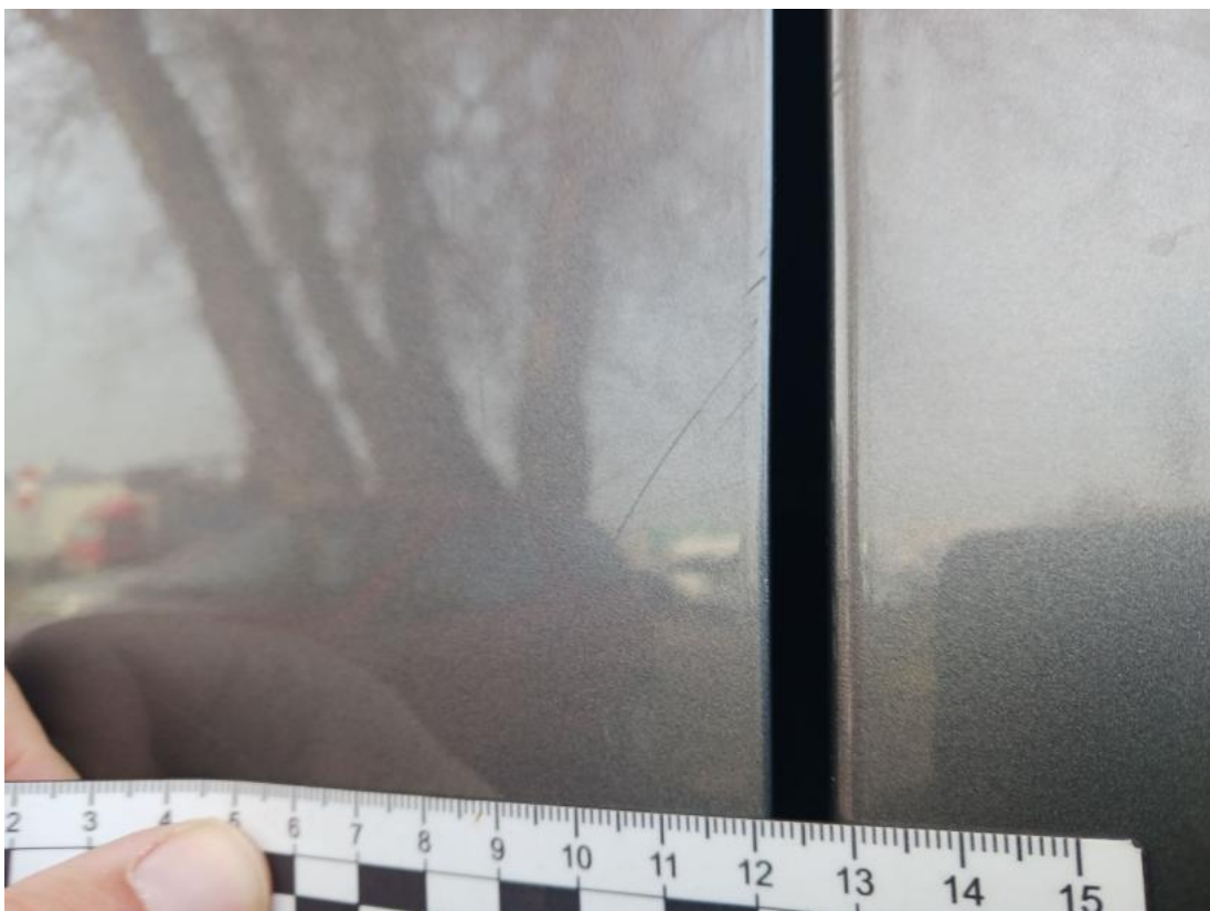
Fot. 40 Drzwi tylne P - Rysa/odprysk 1
