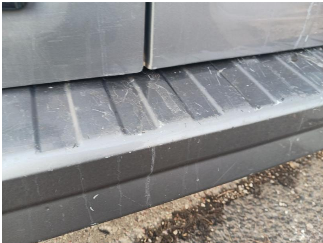
Fot. 55 Zderzak tylny cz śr - Rysa/odprysk 2
