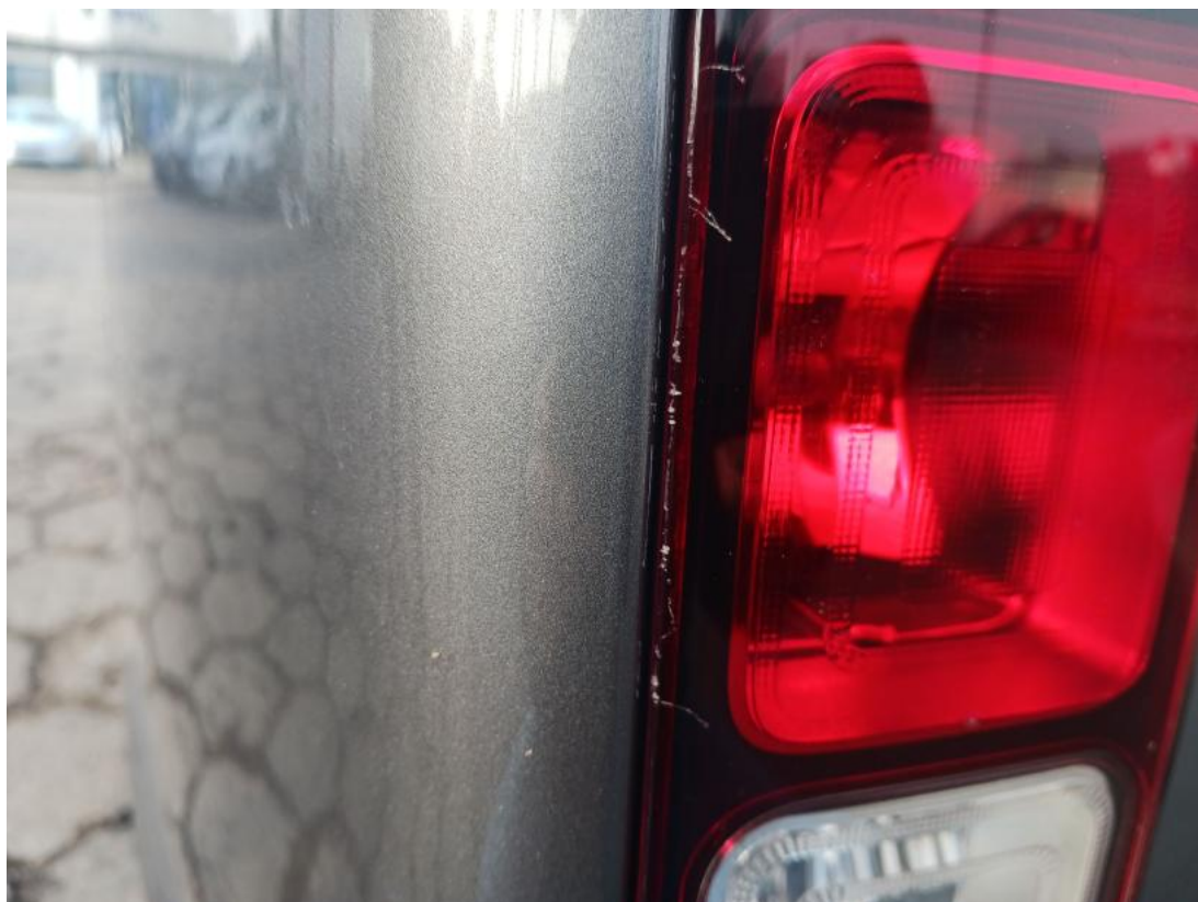
Fot. 59 Lampa przeciwmgielna tylna L - Rysa/odprysk 1
