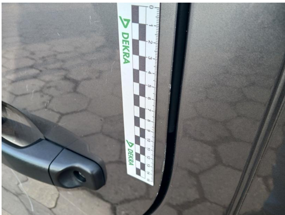
Fot. 60 Drzwi przed L - Rysa/odprysk 1
