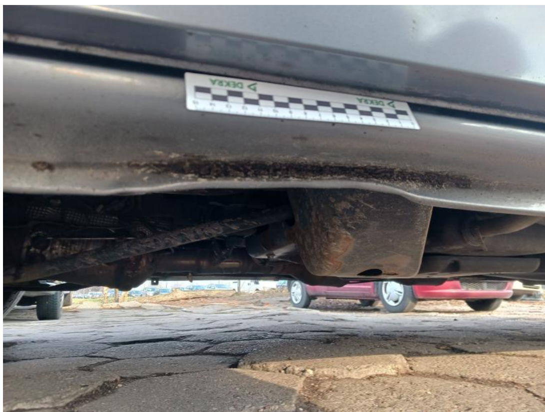
Fot. 64 Próg L - Wgniecenie/odkształcenie 1
