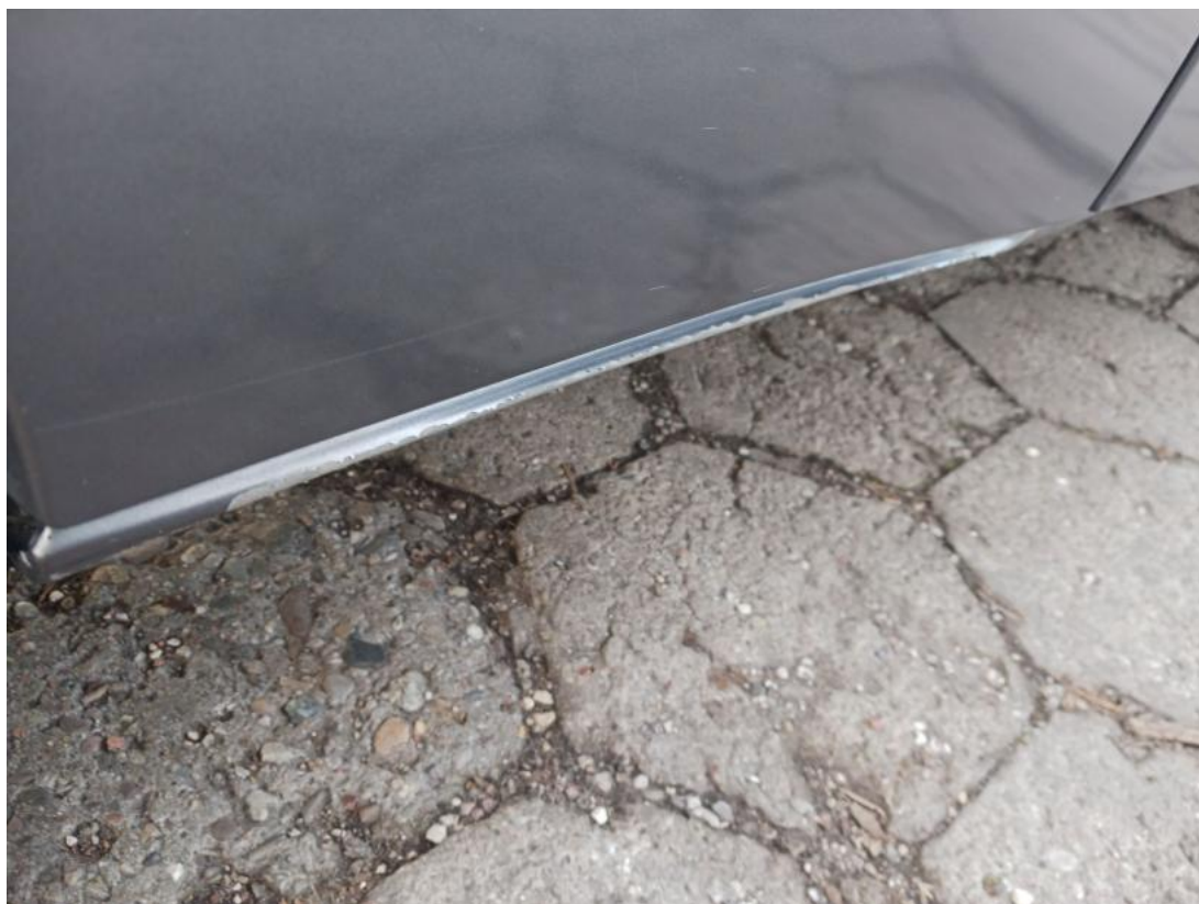
Fot. 45 Próg P - Wgniecenie/odkształcenie 2
