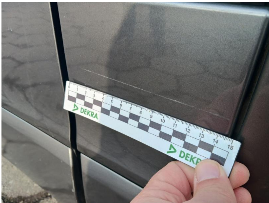
Fot. 67 Słupek środkowy L - Rysa/odprysk 2
