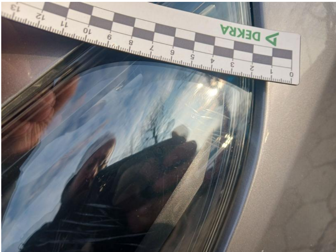
Fot. 71 Reflektor L - Rysa/odprysk 2
