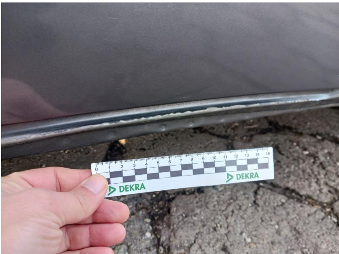
Fot. 44 Próg P - Wgniecenie/odkształcenie 1
