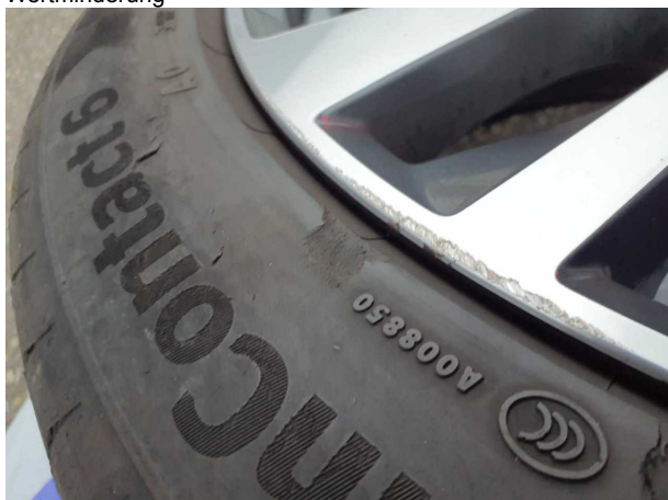
Beschädigung #2: 2.Radsatz: 1 Reifen - beschädigt - erneuern
