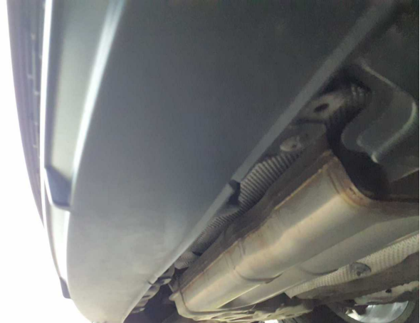
Beschädigung #8: Stossfänger hinten: Stossfänger hinten (Ausschnitt für AHK fehlt) - abweichend Auslieferungszustand -
