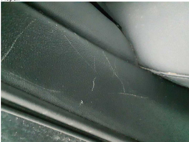
Beschädigung #5: Verkleidungen/Abdeckungen: Innenverkleidung hinten - Kratzer - Wertminderung
