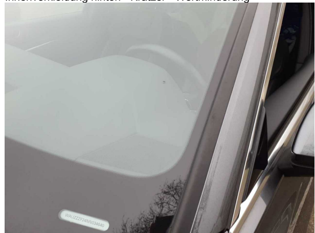
Beschädigung #6: Verglasung: Frontscheibe mit Spurhalteassistent - beschädigt - erneuern
