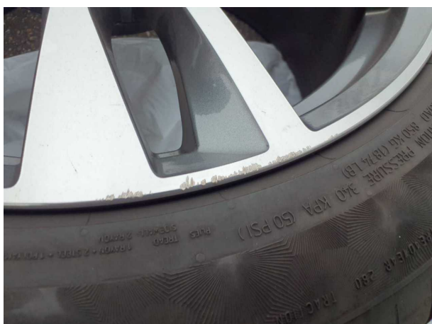
Beschädigung #3: 2.Radsatz: 1 Leichtmetallfelge - beschädigt - Wertminderung
