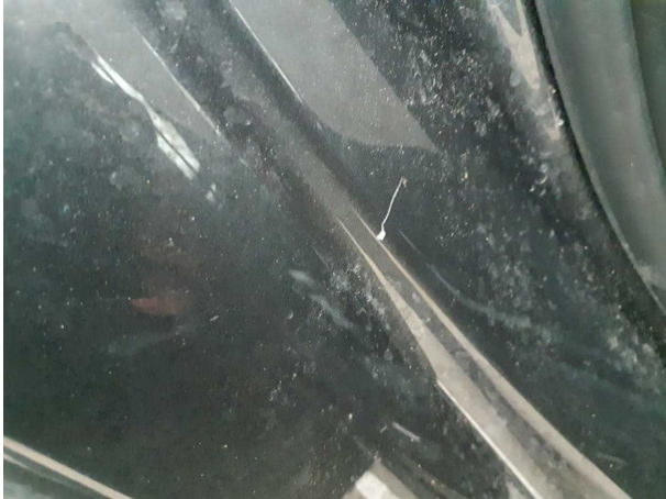
Beschädigung #4: Seitenwand rechts: Einstieg - Kratzer - Smart Repair
