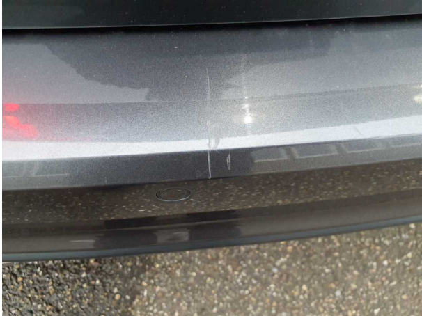
Beschädigung #7: Stossfänger hinten: Stossfänger hinten - Kratzer - Smart Repair
