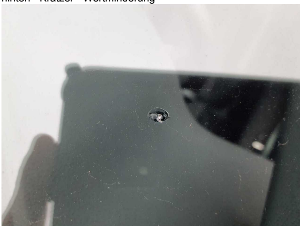
Beschädigung #6: Verglasung: Frontscheibe mit Spurhalteassistent - beschädigt - erneuern
