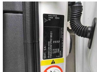
Fahrzeug - Typenschild/Fahrgestellnummer
