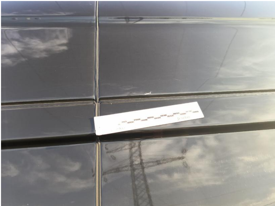
Fot. 75 Błotnik tylny L / Ściana boczna L - Rysa/odprysk 2
