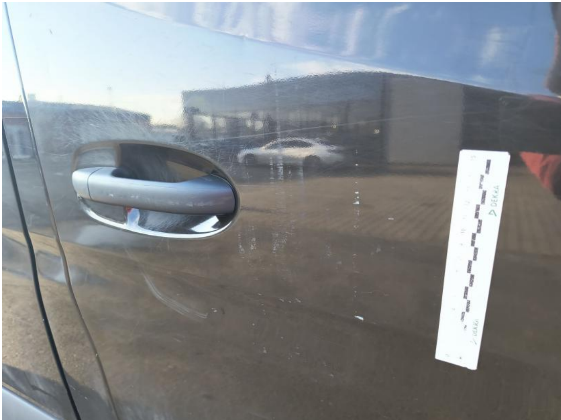
Fot. 41 Drzwi przednie P - Rysa/odprysk 1
