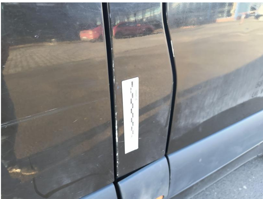
Fot. 54 Słupek środkowy P - Rysa/odprysk 1
