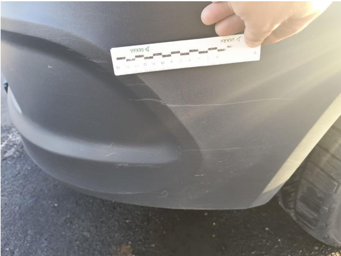
Fot. 37 Zderzak - Rysa/odprysk 2
