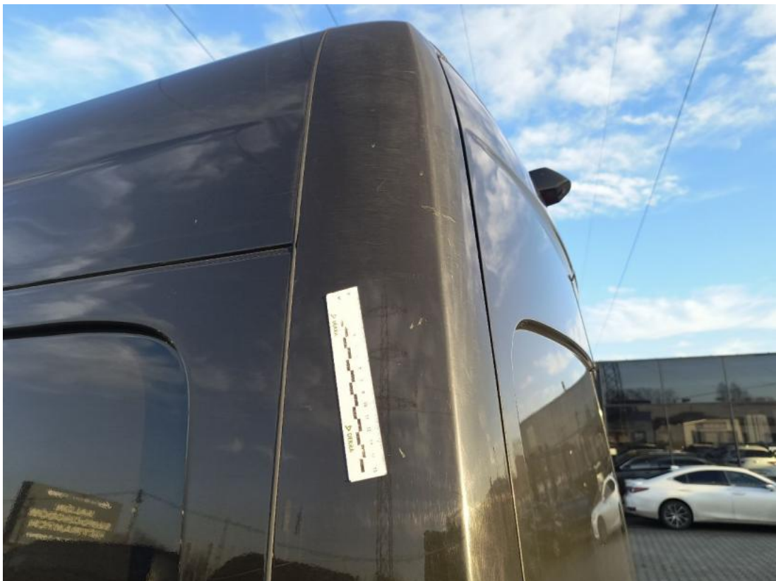
Fot. 82 Słupek tylny lewy - Rysa/odprysk 1
