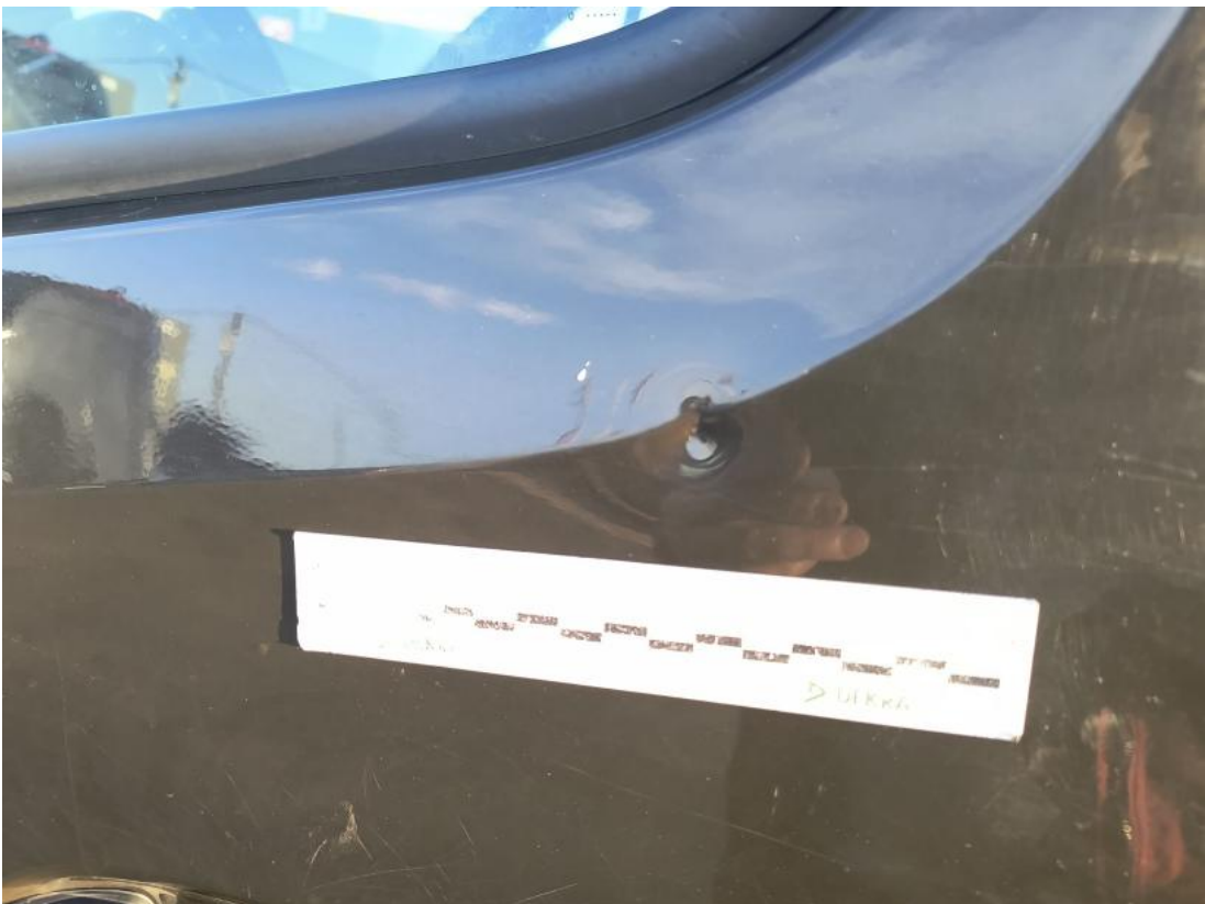
Fot. 86 Drzwi przed L - Wgniecenie/odkształcenie 1
