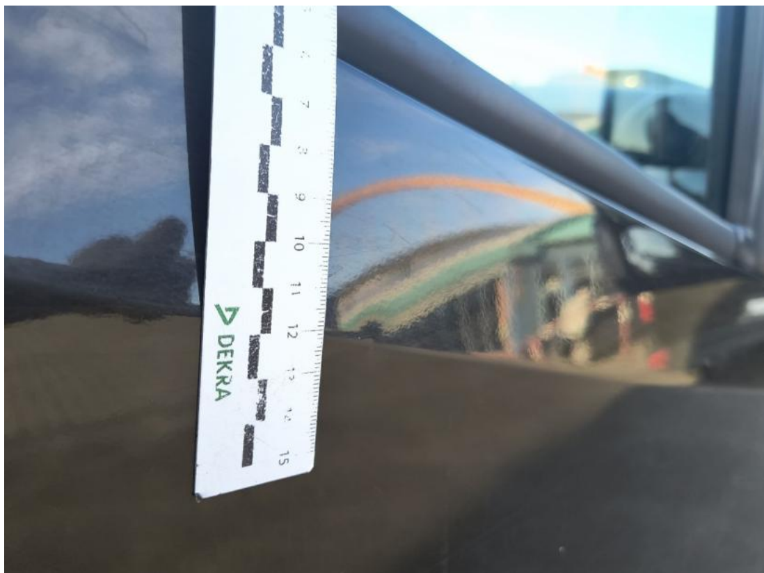
Fot. 44 Drzwi przednie P - Wgniecenie/odkształcenie 2
