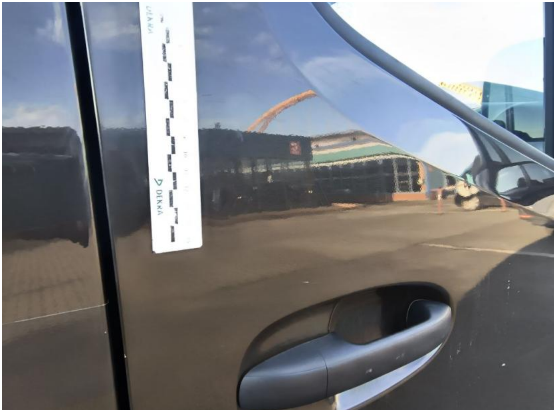
Fot. 43 Drzwi przednie P - Wgniecenie/odkształcenie 1
