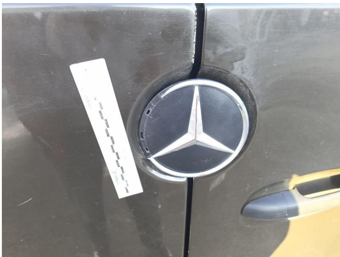
Fot. 60 Emblemat tylny - Pęknięcie/rozerwanie 1
