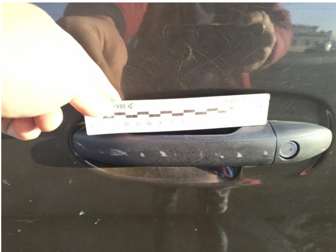
Fot. 88 Klamka drzwi prz L - Rysa/odprysk 1
