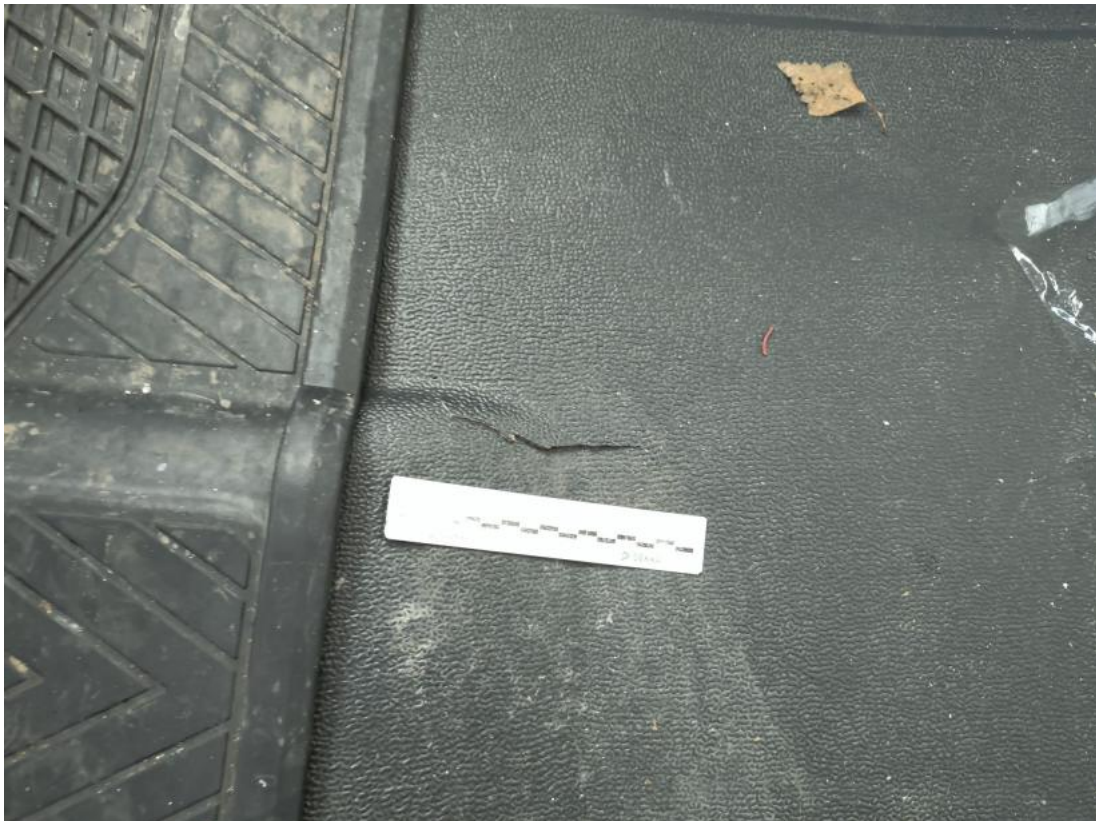
Fot. 105 Wykładzina podłogi - Pęknięcie/rozerwanie 1
