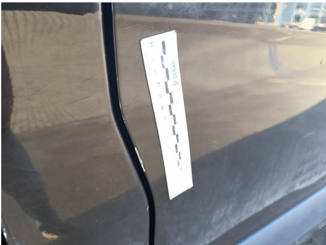
Fot. 42 Drzwi przednie P - Rysa/odprysk 2
