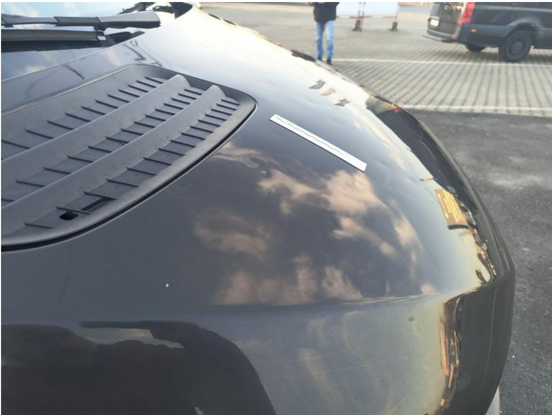
Fot. 37 Pokrywa komory silnika - Wgniecenie/odkształcenie 1
