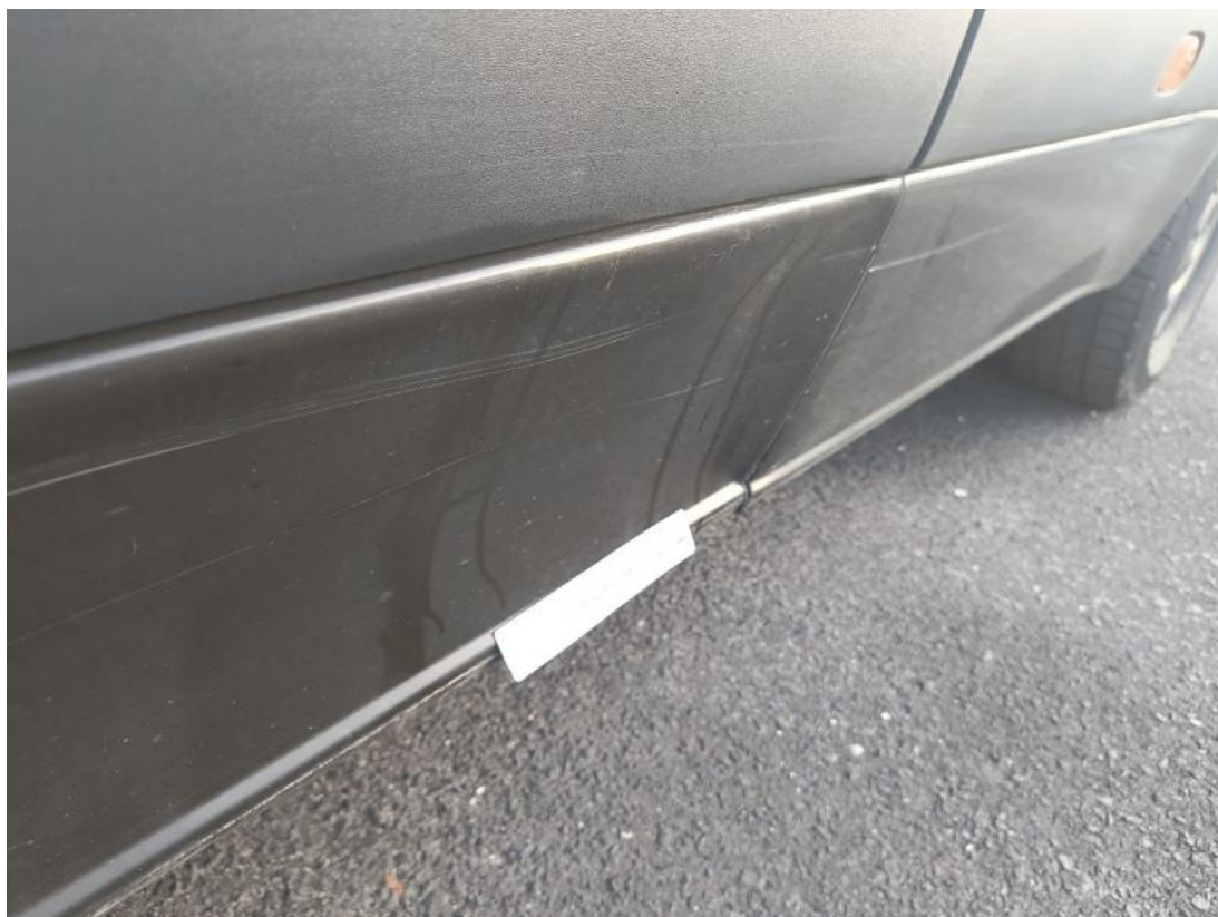
Fot. 89 Drzwi tylne L - Wgniecenie/odkształcenie 2
