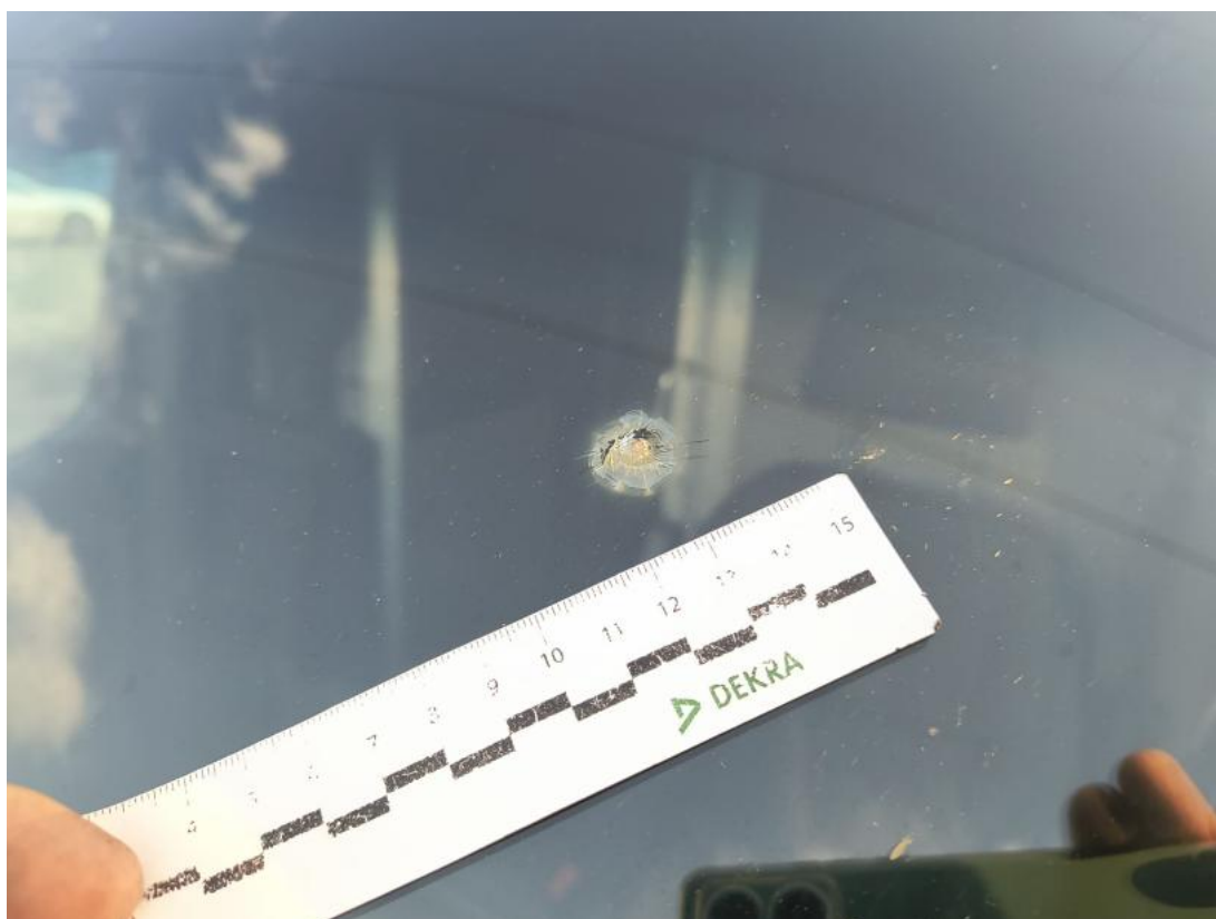
Fot. 41 Szyba czołowa - Pęknięcie/rozerwanie 1
