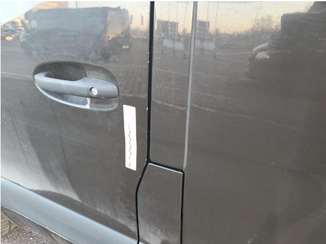
Fot. 83 Drzwi przed L - Rysa/odprysk 2
