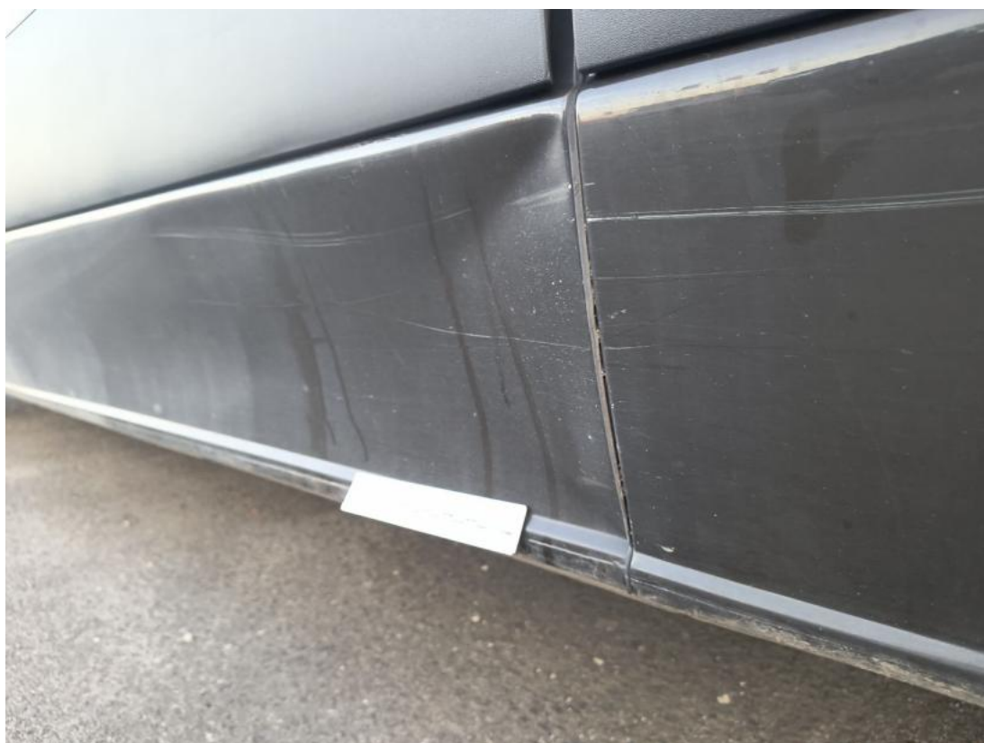
Fot. 90 Drzwi tylne L() - Wgniecenie/odkształcenie 3
