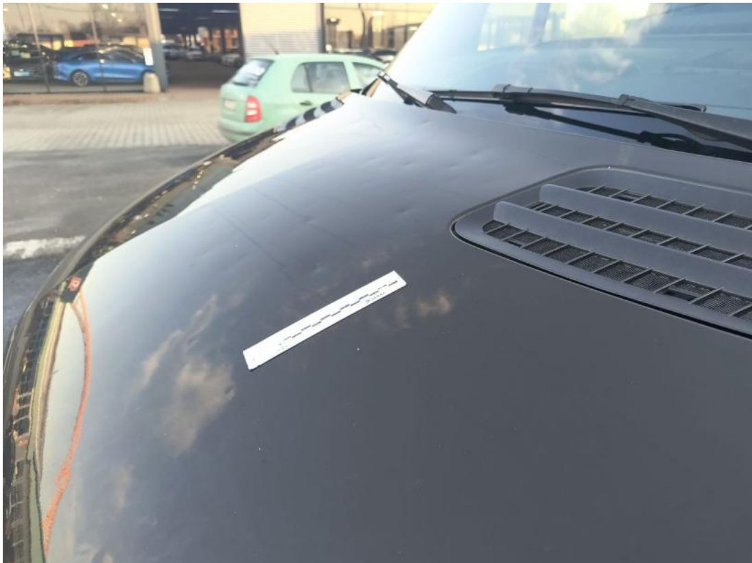
Fot. 39 Pokrywa komory silnika() - Wgniecenie/odkształcenie 3
