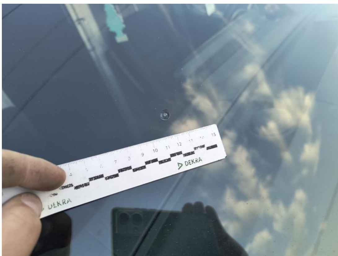
Fot. 42 Szyba czołowa - Pęknięcie/rozerwanie 2
