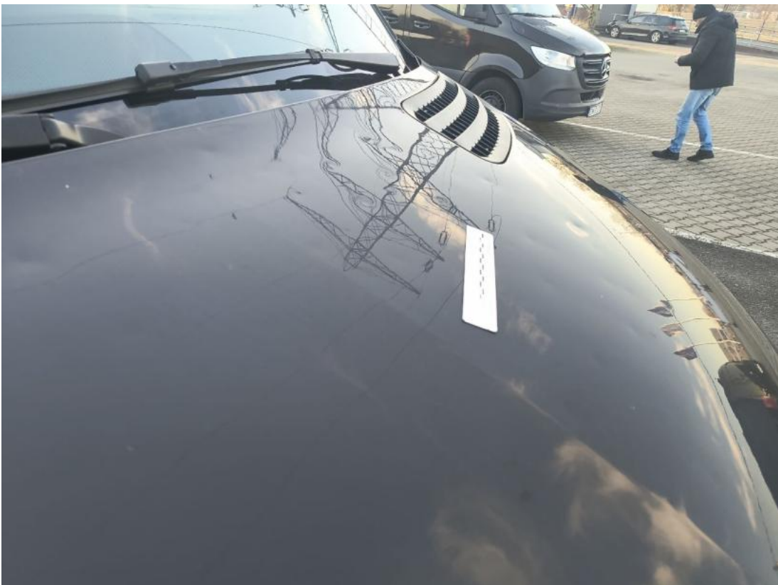
Fot. 38 Pokrywa komory silnika - Wgniecenie/odkształcenie 2
