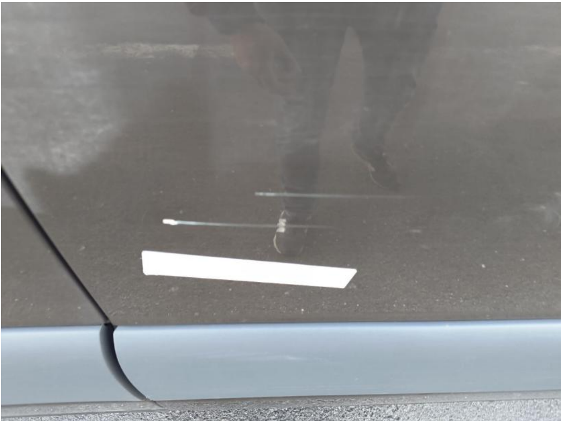
Fot. 51 Drzwi tylne P() - Rysa/odprysk 3
