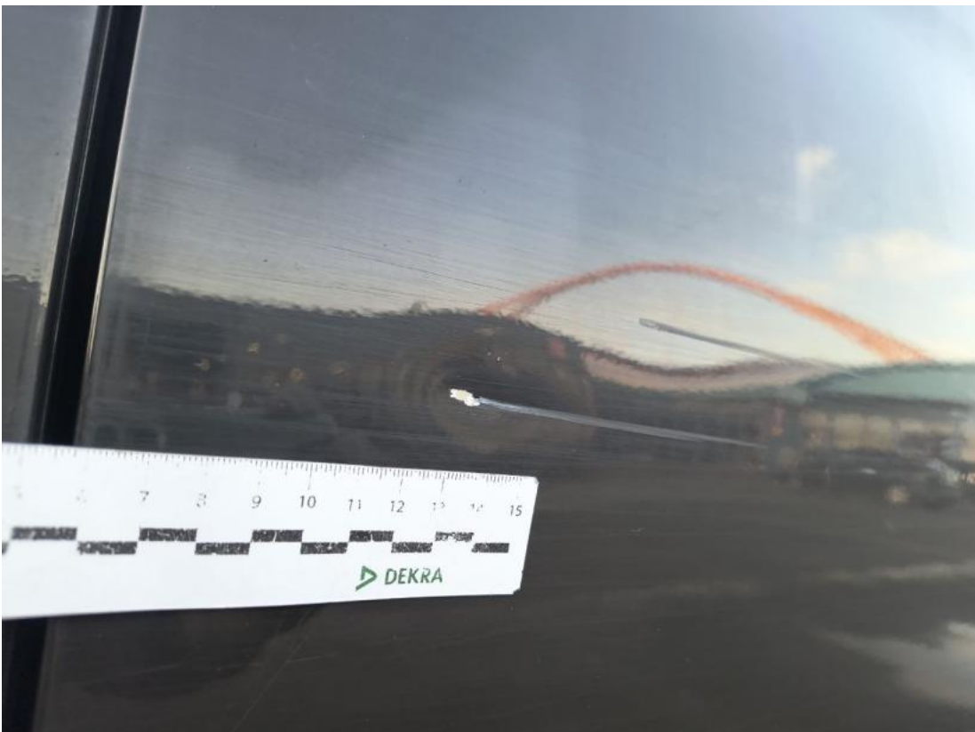
Fot. 52 Drzwi tylne P - Wgniecenie/odkształcenie 1
