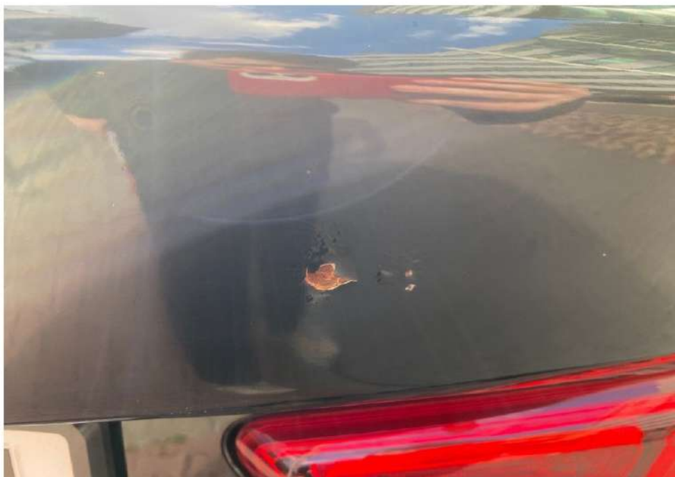
Wykwit korozji podpowłokowej
