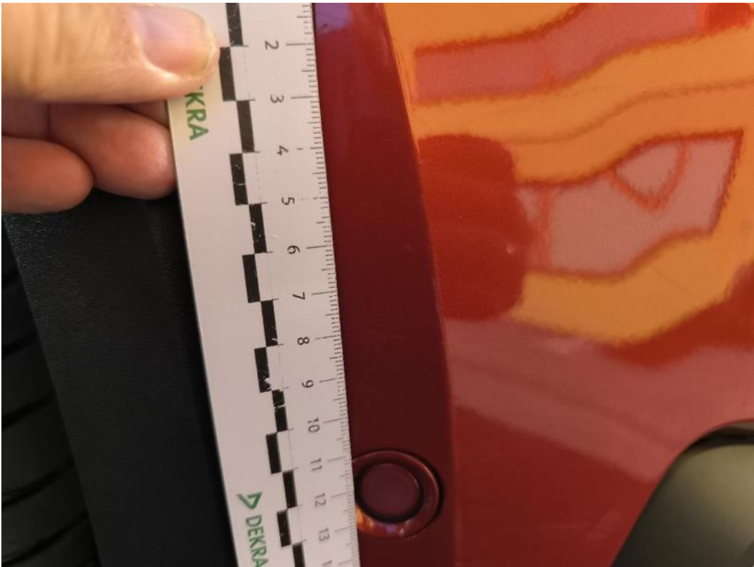
Fot. 43 Zderzak() - Rysa/odprysk 3
