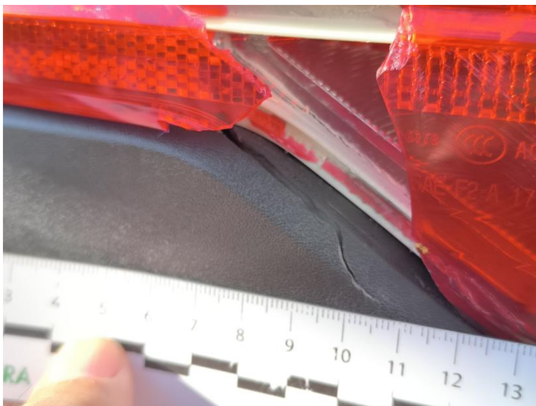
Fot. 58 Zderzak tylny - Pęknięcie/rozerwanie 1
