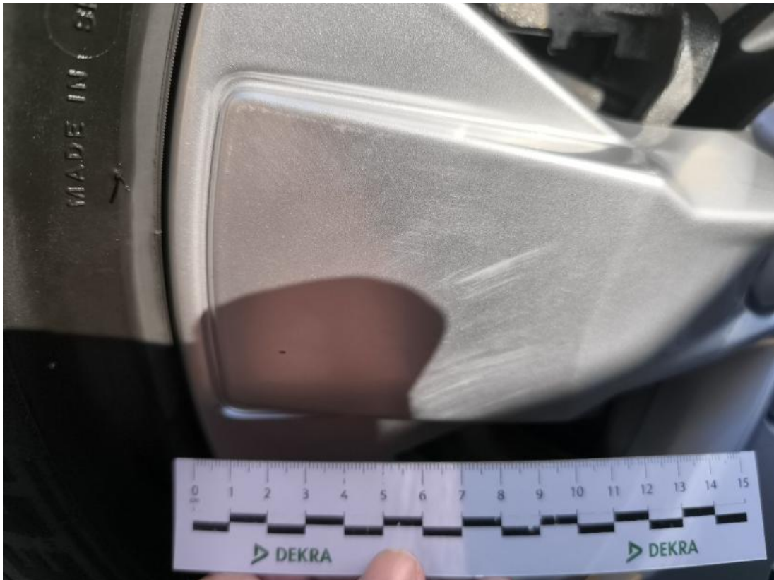
Fot. 73 Felga Aluminiowa przednia L - Rysa/odprysk 2
