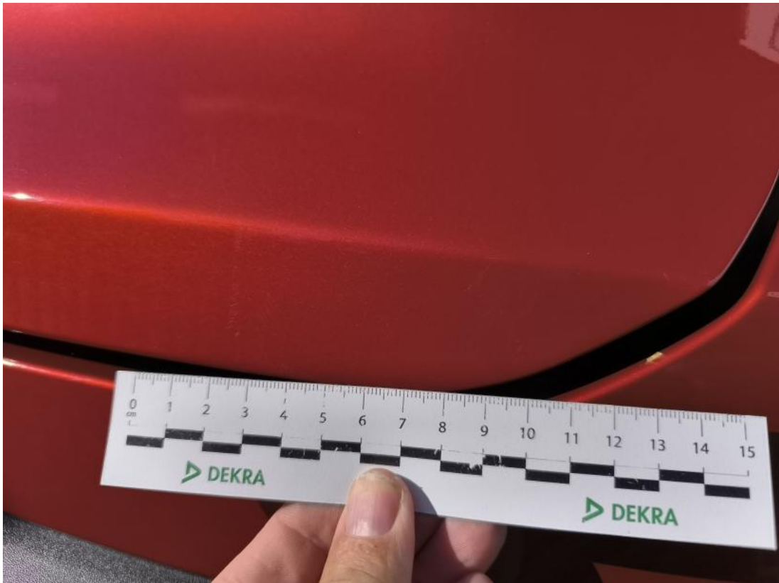
Fot. 51 Pokrywy bagażnika - Rysa/odprysk 1
