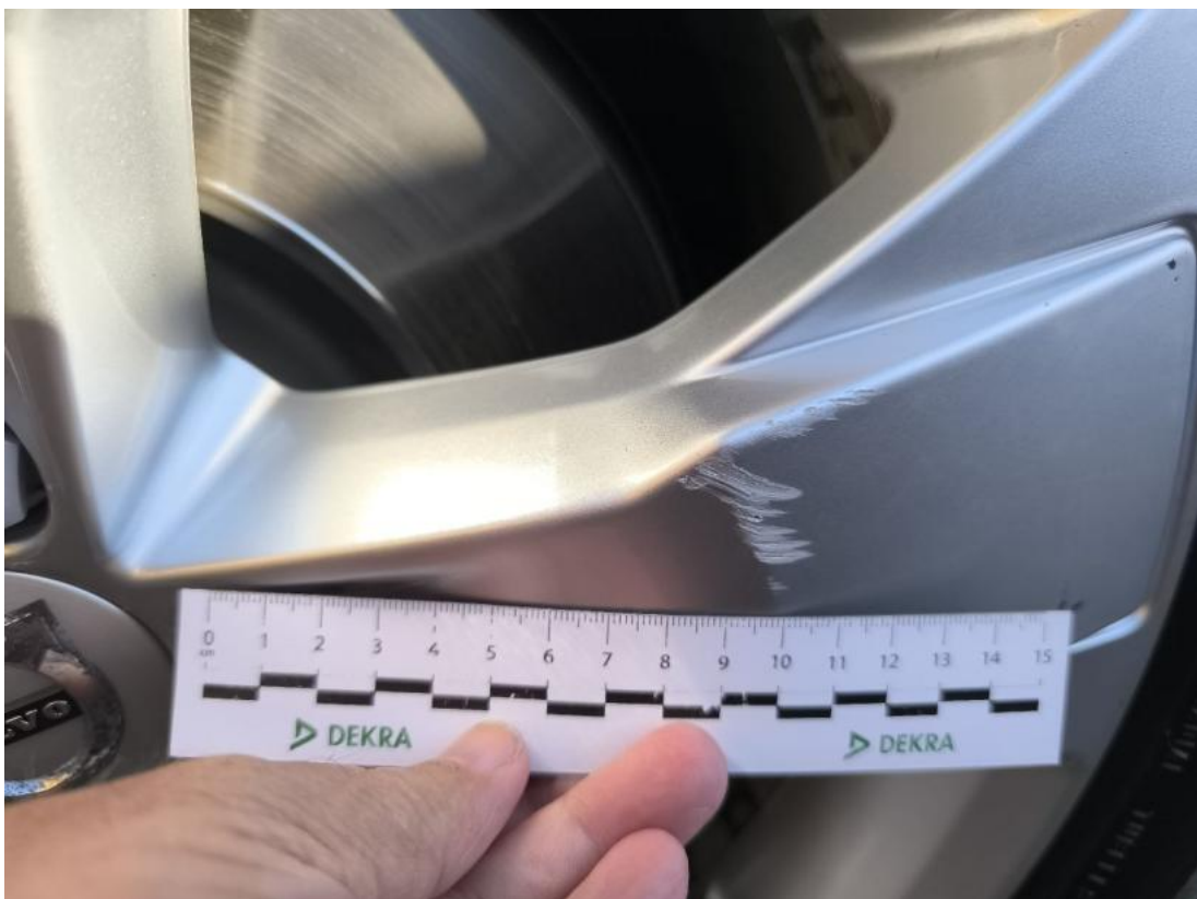
Fot. 74 Felga Aluminiowa przednia L() - Rysa/odprysk 3
