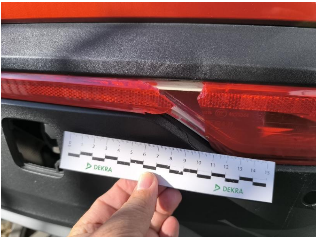
Fot. 52 Światło odblaskowe tylne - Pęknięcie/rozerwanie 1
