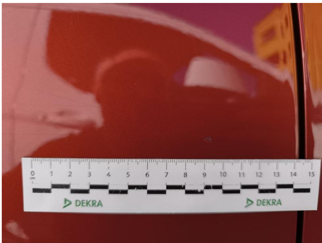
Fot. 47 Drzwi tylne P - Rysa/odprysk 1
