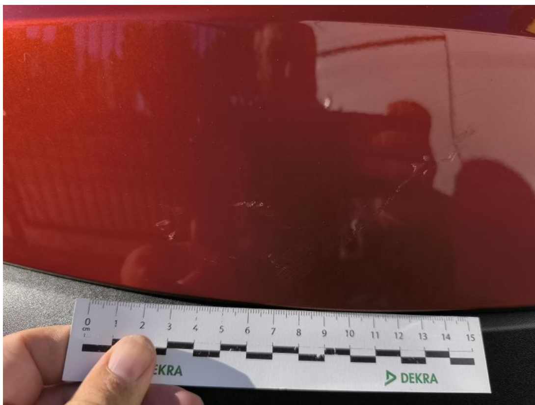
Fot. 57 Zderzak tylny() - Rysa/odprysk 3
