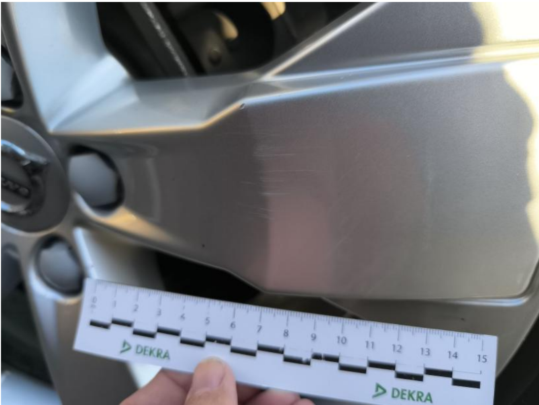
Fot. 59 Felga aluminiowa tylna L - Rysa/odprysk 1
