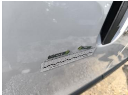
Fot. 42 Drzwi tylne P() - Wgniecenie/odkształcenie 3
