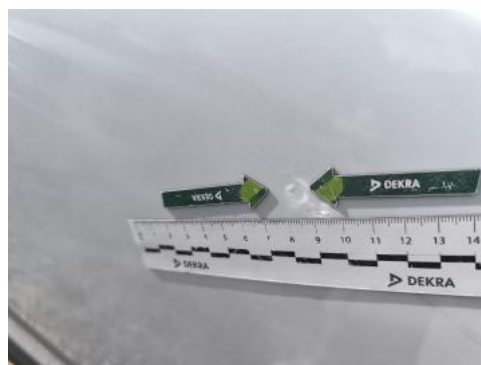
Fot. 40 Drzwi przednie P() - Wgniecenie/odkształcenie 3
