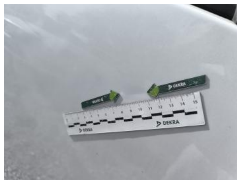
Fot. 38 Drzwi przednie P - Wgniecenie/odkształcenie 1
