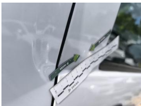
Fot. 39 Drzwi przednie P - Wgniecenie/odkształcenie 2
