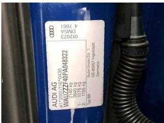
Fahrzeug - Typenschild/Fahrgestellnummer
