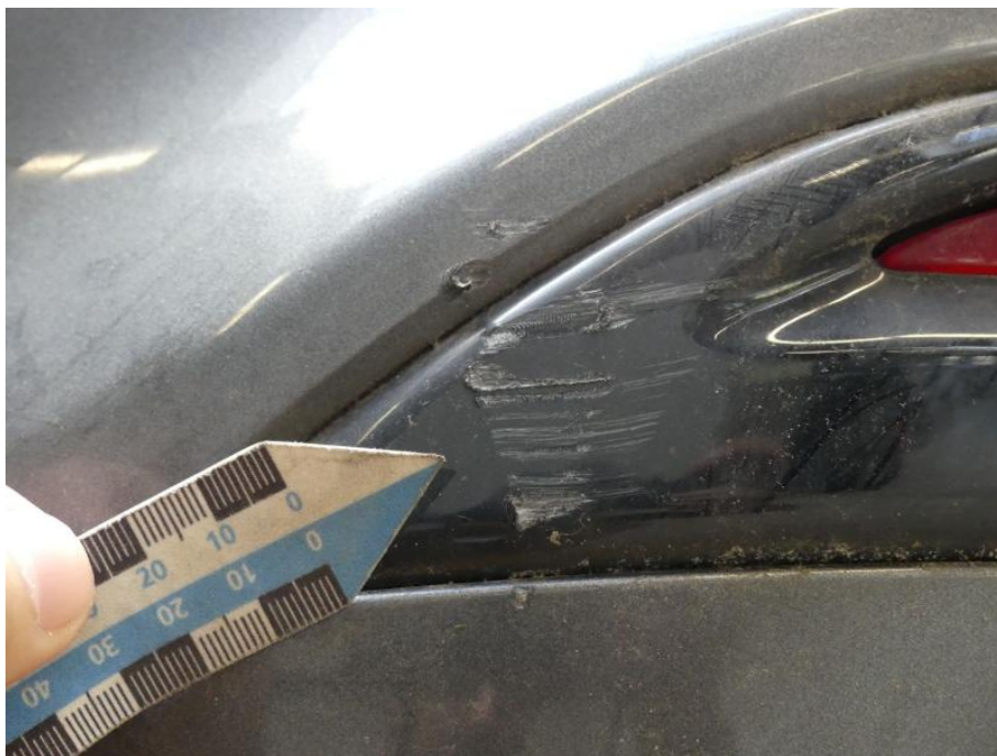
Bild 13 Fahrzeugheck Stoßfängerspoiler hinten verkratzt
