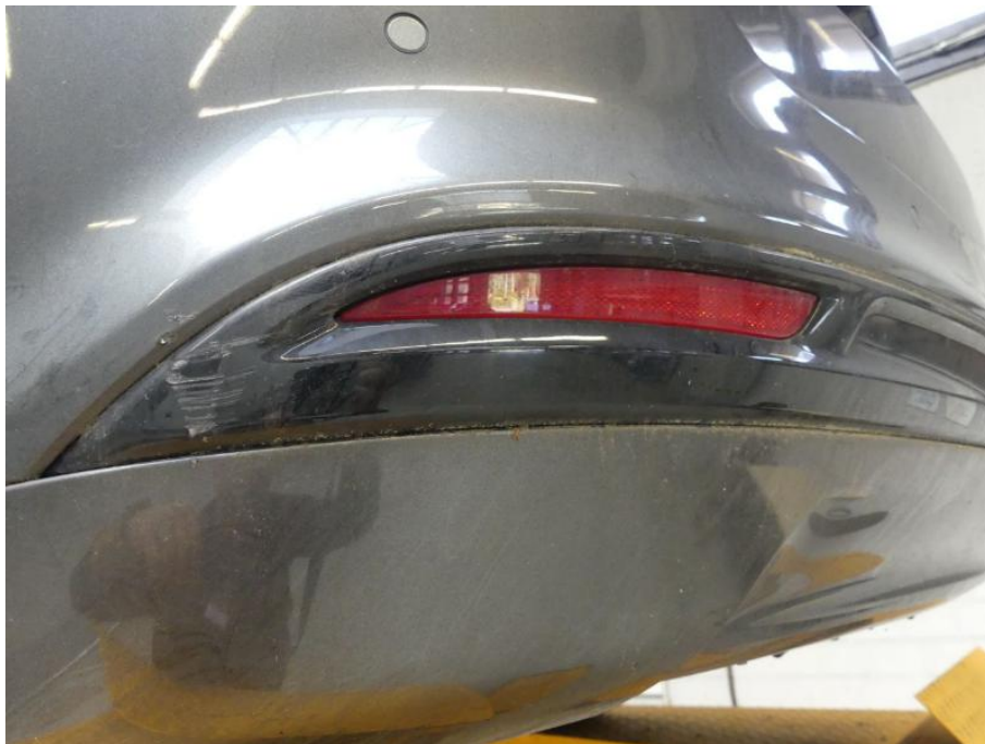
Bild 12 Fahrzeugheck Stoßfängerspoiler hinten verkratzt
