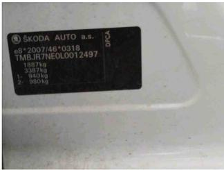
Fahrzeug - Typenschild/Fahrgestellnummer
