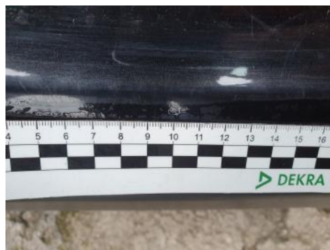
Fot. 42 Próg P - Rysa/odprysk 1
