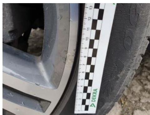
Fot. 46 Felga przednia L - Rysa/odprysk 1
