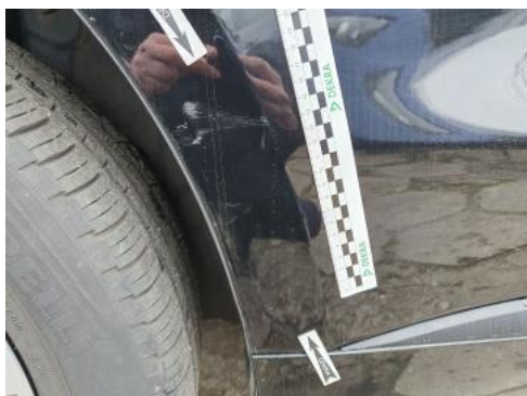
Fot. 41 Drzwi tylne P - Wgniecenie/odkształcenie 1
