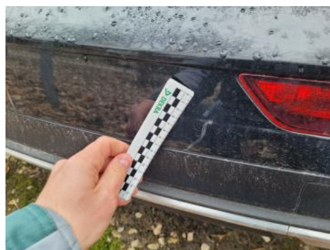
Fot. 32 Zderzak tylny - Rysa/odprysk 1
