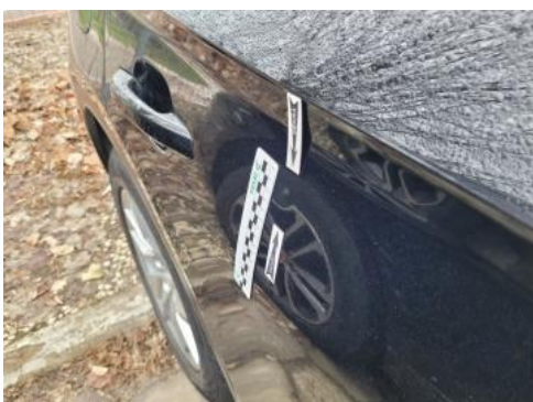
Fot. 31 Drzwi tylne P - Wgniecenie/odkształcenie 1
