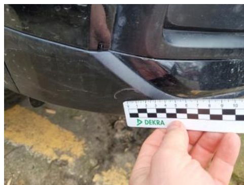
Fot. 30 Zderzak() - Rysa/odprysk 3
