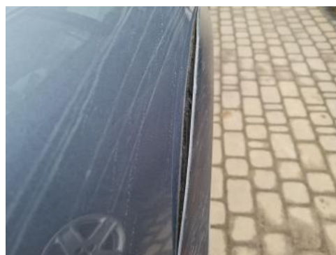
Fot. 52 Listwa krawędzi błotnika tyl P - Wgniecenie/odkształcenie 1
