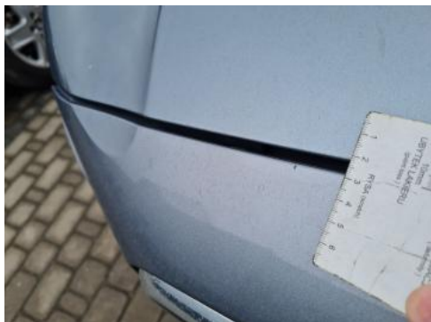
Fot. 49 Zderzak - Rysa/odprysk 2
