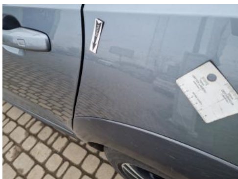
Fot. 53 Błotnik tylny L / Ściana boczna L - Rysa/odprysk 1
