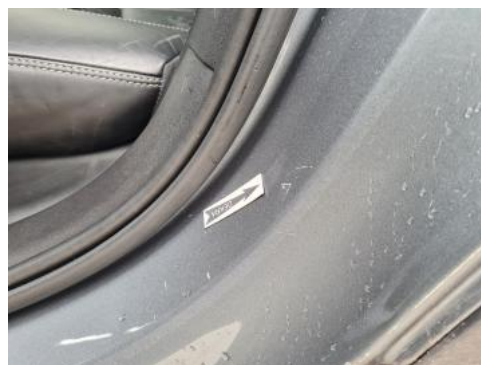
Fot. 54 Błotnik tylny L / Ściana boczna L - Rysa/odprysk 2
