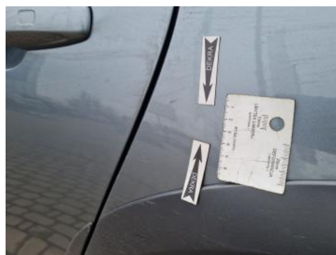
Fot. 56 Błotnik tylny L / Ściana boczna L - Wgniecenie/odkształcenie 1
