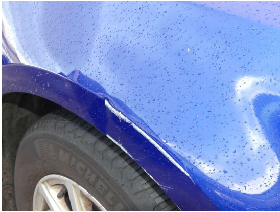
Bild 1: Karosserie / Kotflügel rechts defomiert
