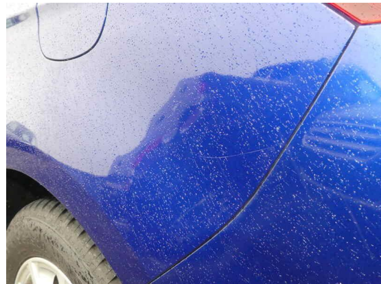
Bild 4: Karosserie / Seitenwand links Kratzer
