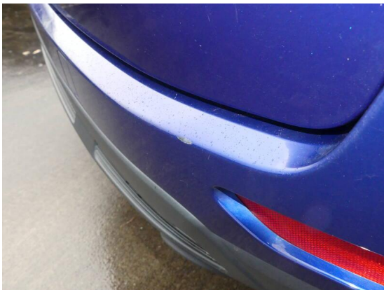
Bild 5: Karosserie / Stoßfänger hinten Kratzer
