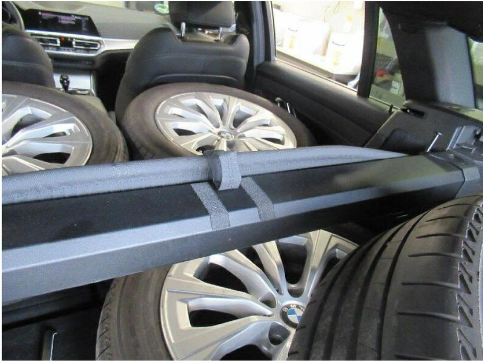
Bild 15 : leicht entfernbare Teile (Hutablage, Netztrennwand, ...)
